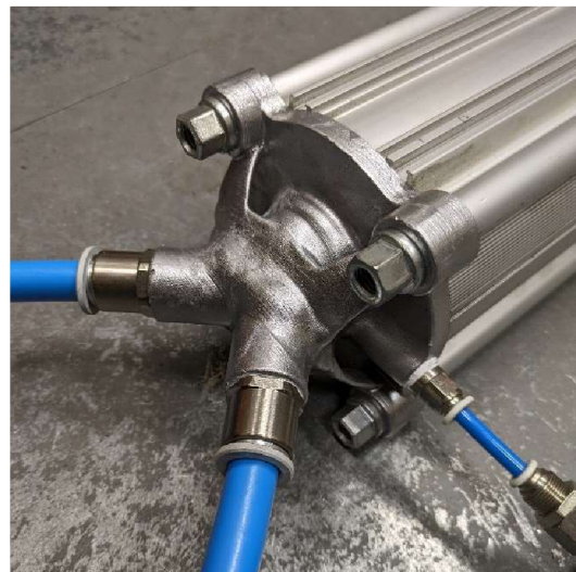
Obr. 29 Montáž čela válce
