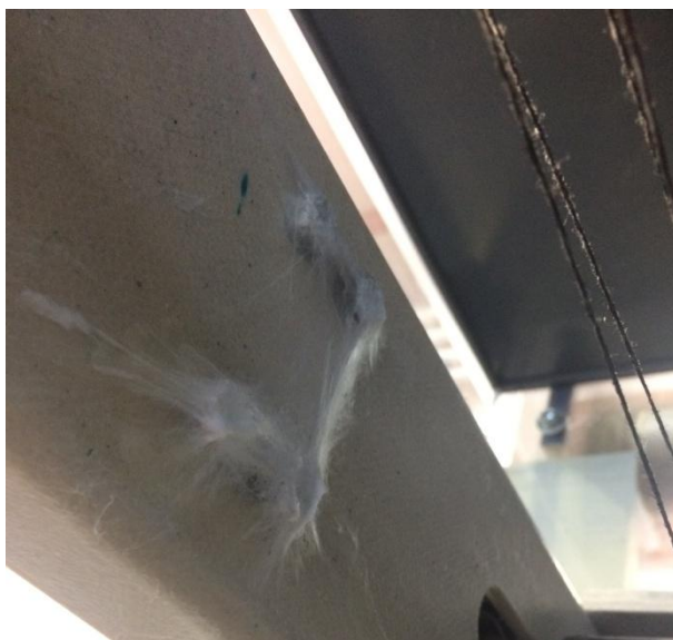
Obrázek 69.: Zanášení komponent ve stávajícím řešení [vlastní]
