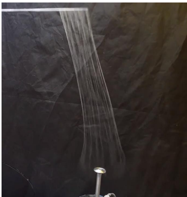
Obrázek 66.: Nanášení nanovláken střídavým napětím [vlastní]
