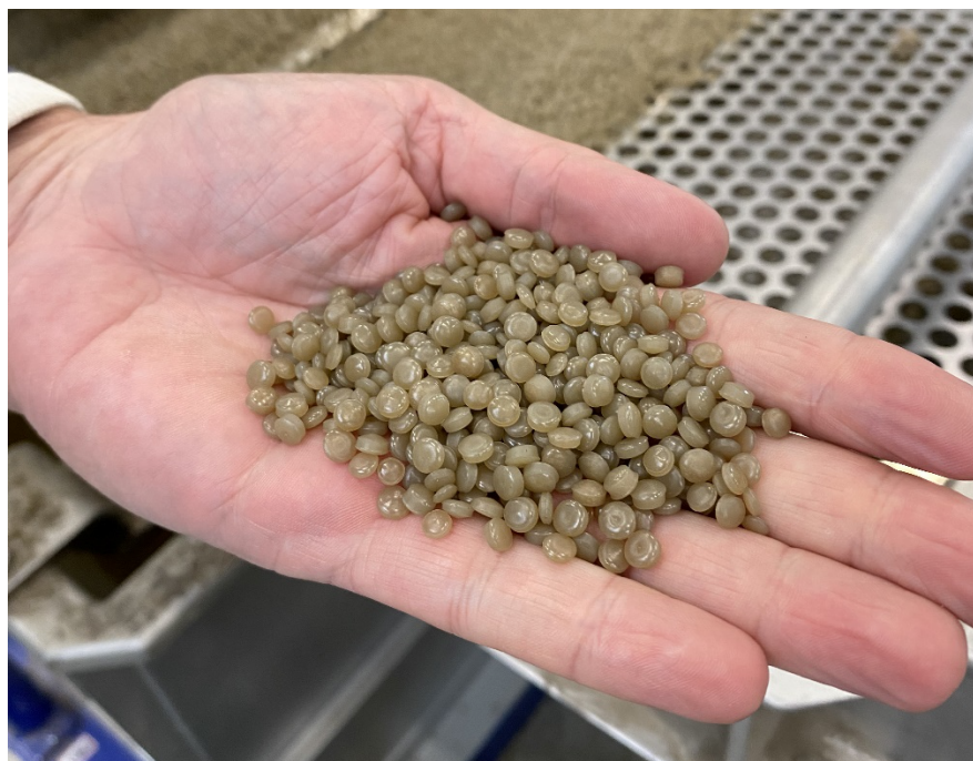
Obr. 11 Výstup recyklační linky – regranulát
