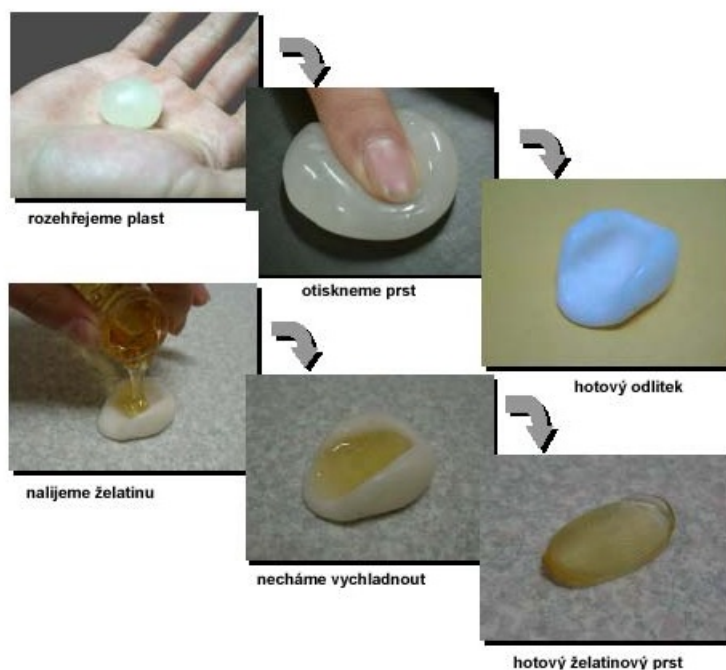
Obrázek 45: Postup tvorby želatinového prstu [50]
