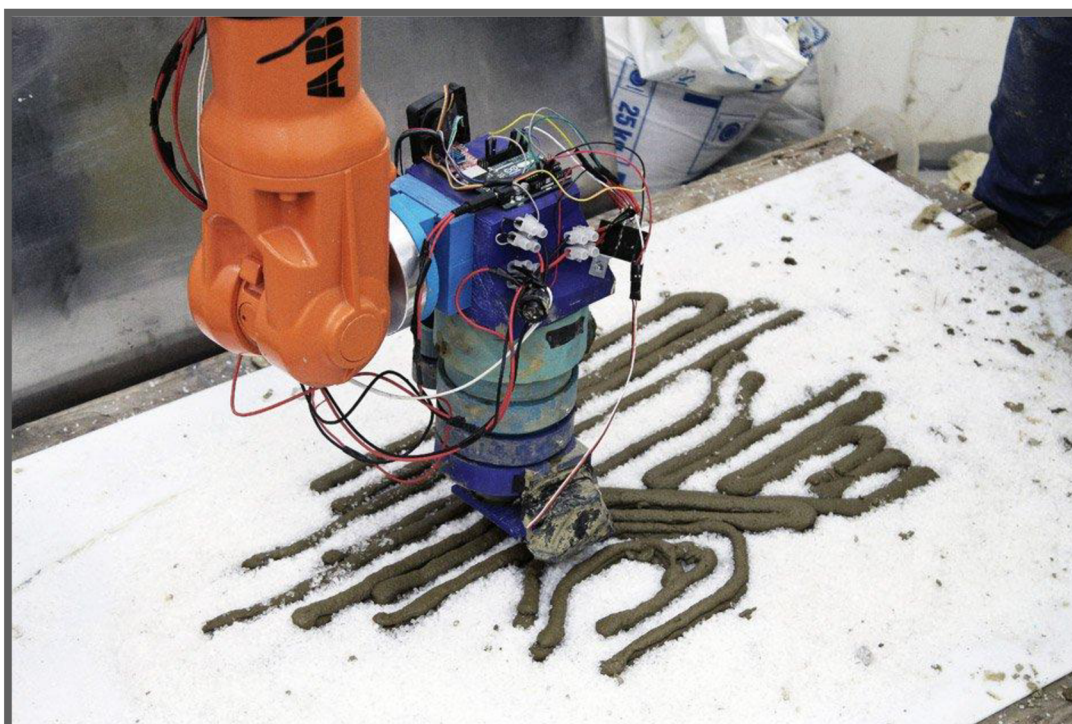
Obr. 2-2 Aktivní tisková hlava, tisk s podporami [3]
