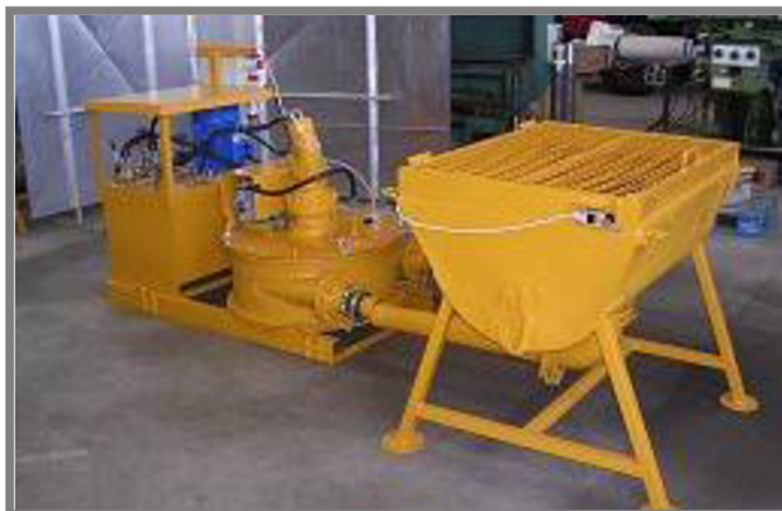
Obr. 2-11 Peristaltické čerpadlo na beton P 65 [15]
