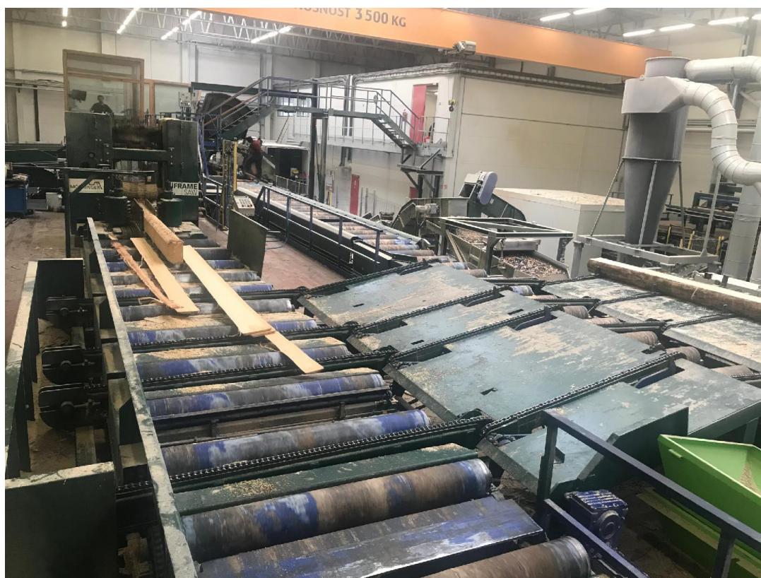
Obrázek 5: Rámová pila a válečkový dopravník
