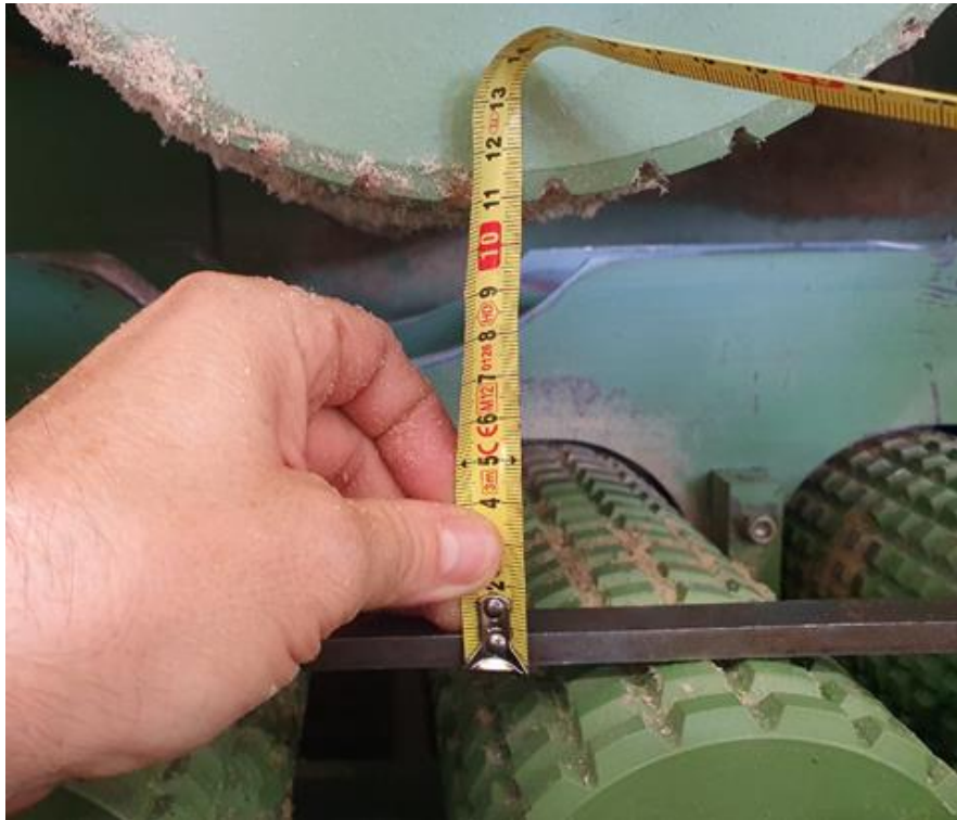
Obrázek 18: Měření výšky přítlačných válců
