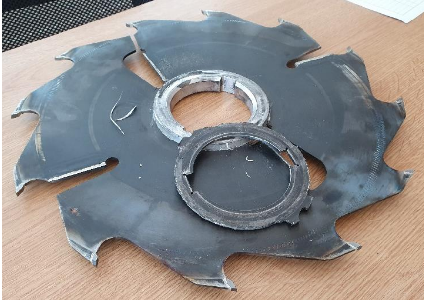
Obrázek 13: Utržený kotouč na vymešovacím kroužku
