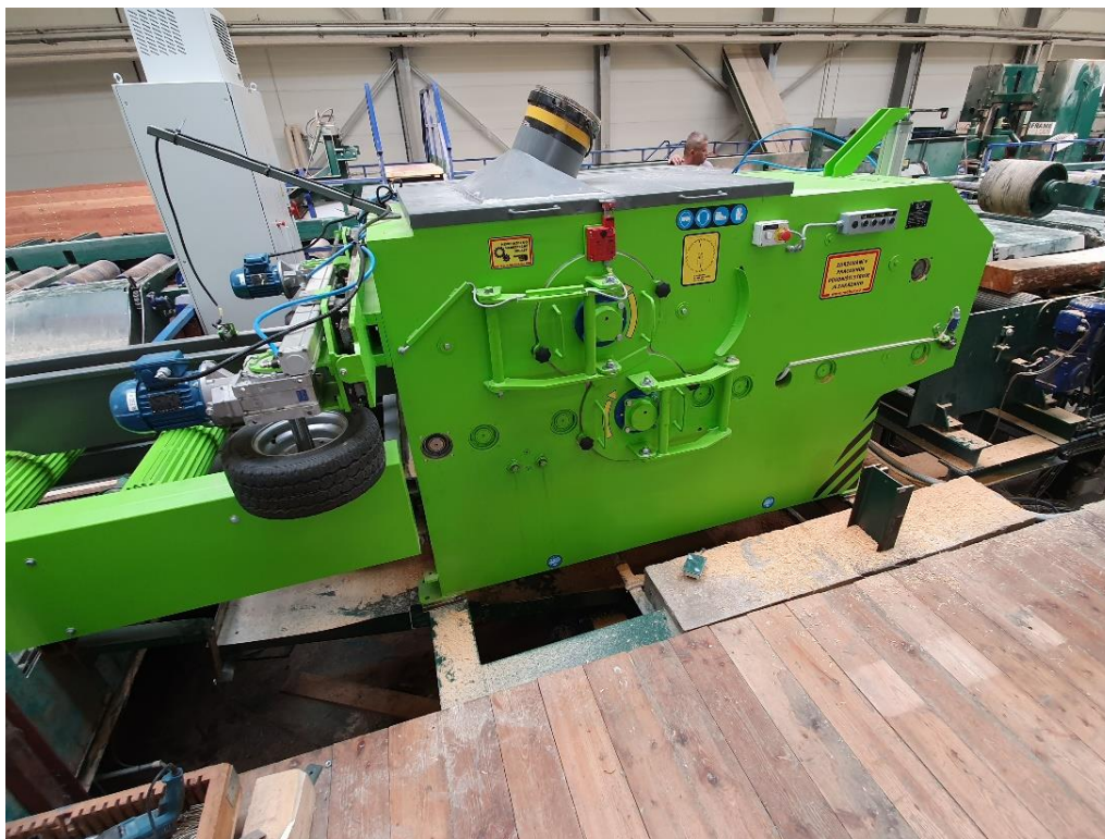
Obrázek 25: Rozmítací pila Mebor VC 900 DE26
