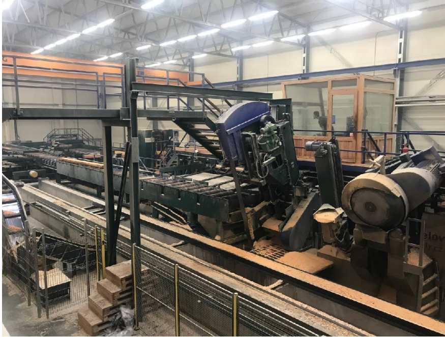
Obrázek 2: Uspořádání pásové a rámové pily
