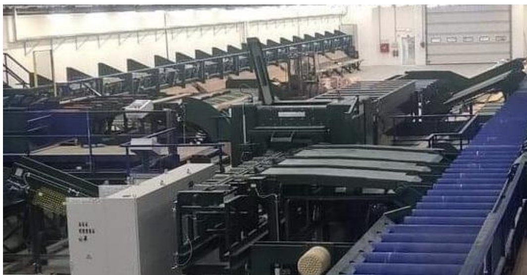
Obrázek 8: Rozmítací pila Möhringer MN 180
