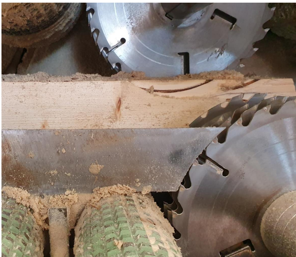
Obrázek 23: Postavení klínu vůči pilovému kotouči po úpravě profilu
