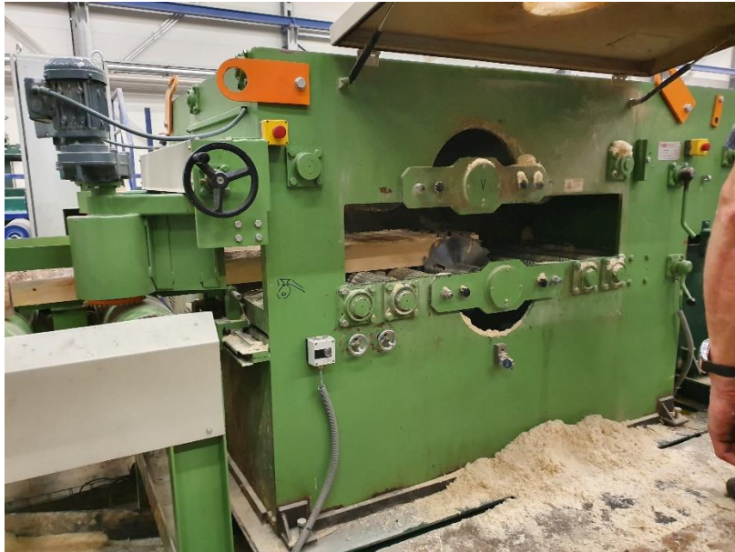
Obrázek 11: Zakrytování pilových hřídelí
