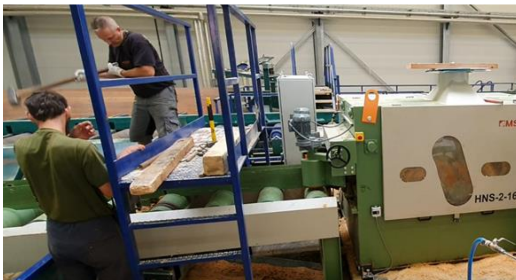
Obrázek 16: Vytloukání zaseklé prizmy palicí
