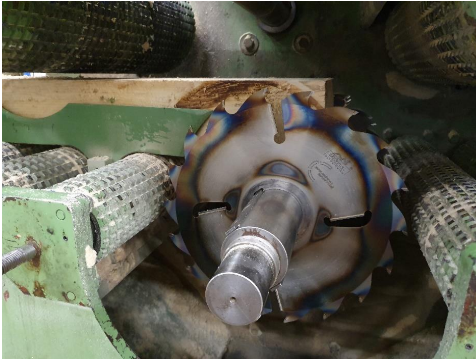
Obrázek 21: Spálený pilový kotouč
