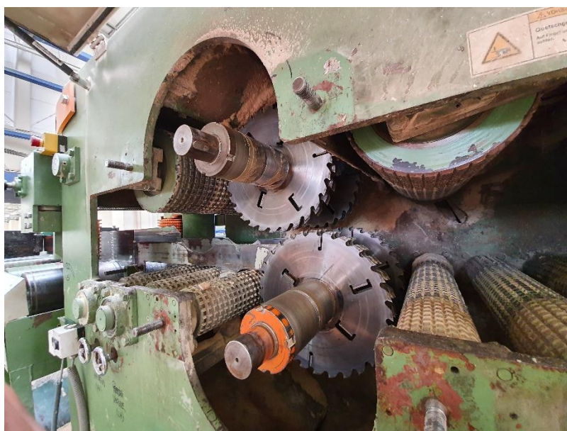
Obrázek 10: Celkový pohled do rozmítací pily MS
