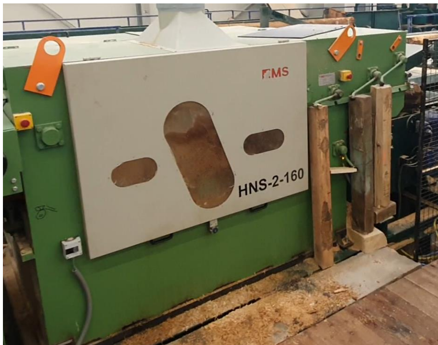
Obrázek 15: Podepření bezpečnostních klínů
