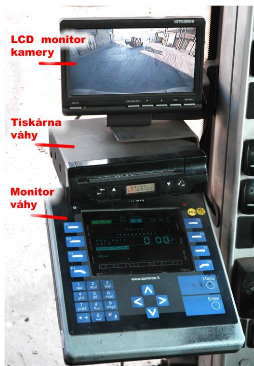
Obrázek 14: LCD monitor a tenzometrická váha s tiskárnou
