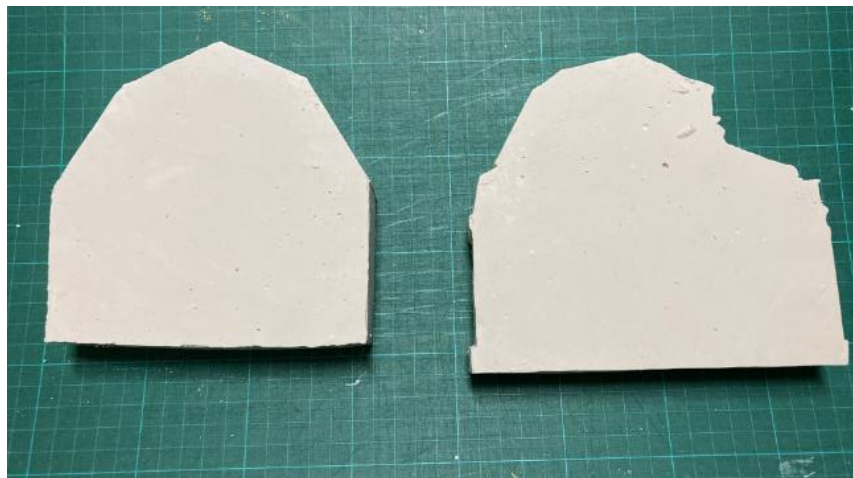
Obrázek 47: Zarovnané odlité bloky sádry po sundání formy
