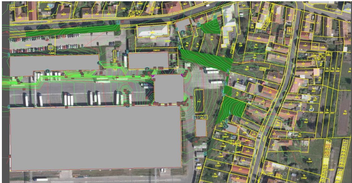
Obrázek 19 Šíření hluku vrtnou soupravou 2
