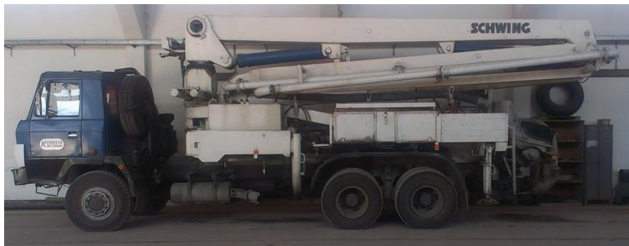
Obrázek 24 Čerpadlo na beton
