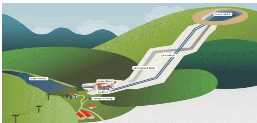
Obrázek 8 - Schéma přečerpávací elektrárny
