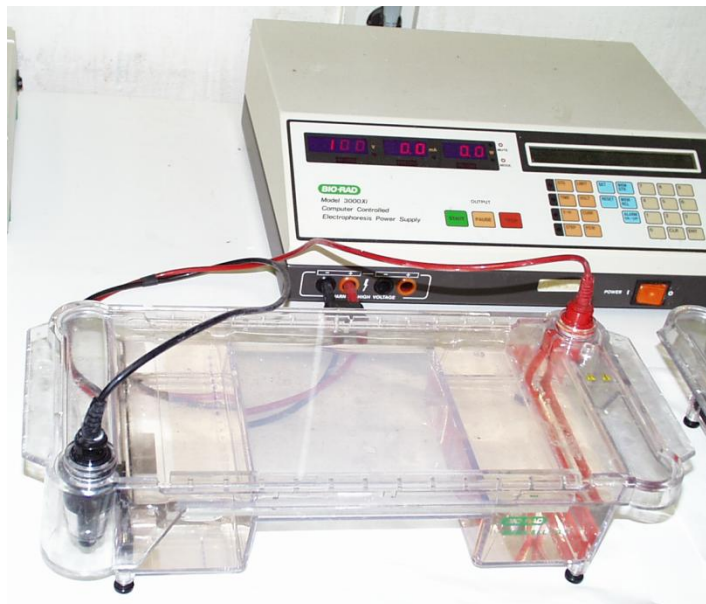
Obrázek 6: Elektroforetická aparatura SubCell (BioRad)
