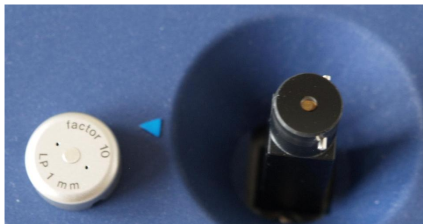
Obrázek 7: Detailní pohled na kapku roztoku DNA nanesenou na měřící část UV-spektrofotometru NanoPhotometer (Implen)
