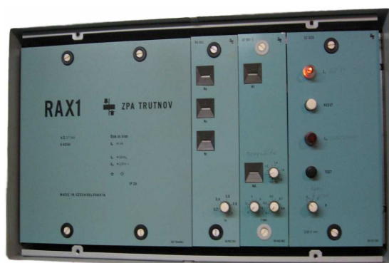
Obrázek 5.7 Elektronická diferenciální ochrana RAX1, n.p. ZPA Trutnov
