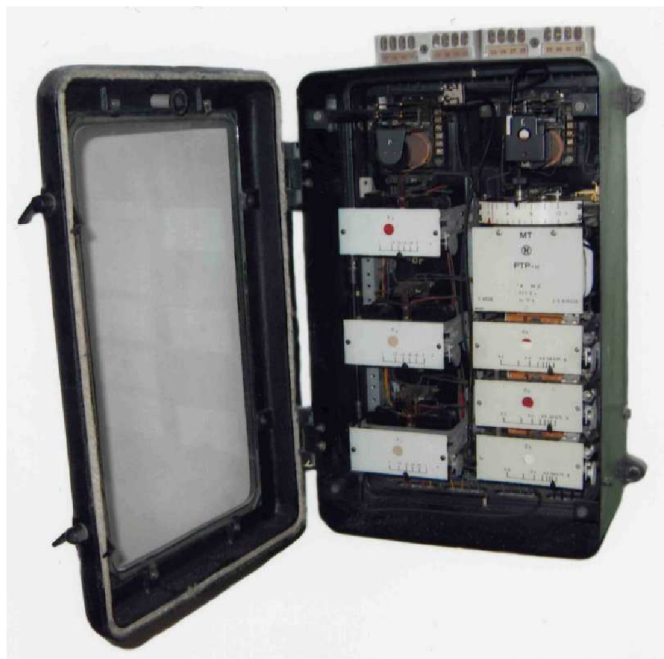
Obrázek 5.5 Elektromechanická diferenciální ochrana PTP od firmy Křižík, n.p.
