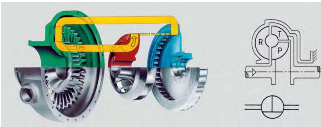
Obr. 6 Hydrodynamický měnič, červeně čerpadlové kolo, modře turbínové kolo, zeleně reakční člen, žlutě proudění pracovní kapaliny [10]
