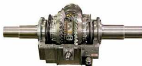
Obr. 3 Nápravová převodovka s reverzací firmy Gmeinder [7]. Výkon je přenášen pravým nebo levým kuželovým kolem, přičemž druhé je odděleno od hřídele pomocí spojky [7]
