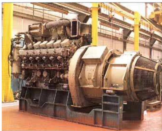
Obr. 20 Spalovací motor s alternátorem z hnacích vozů britského HST [25]
