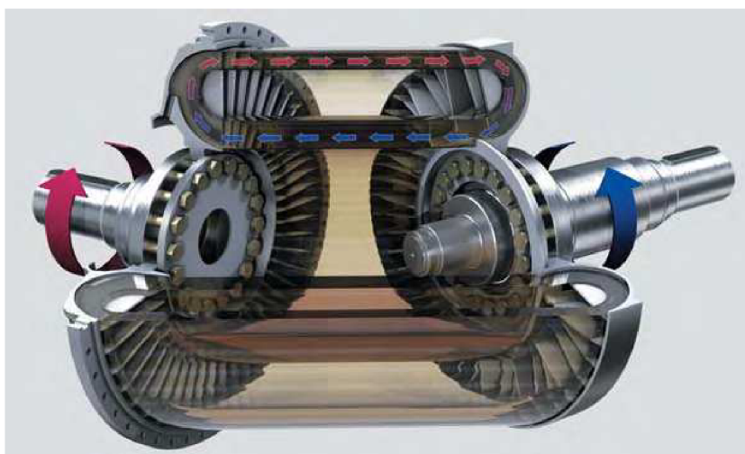
Obr. 5 Hydrodynamická spojka, vlevo čerpadlové kolo, vpravo turbínové kolo, šipky znázorňují směr pohybu hřídelů a pracovní kapaliny [10]
