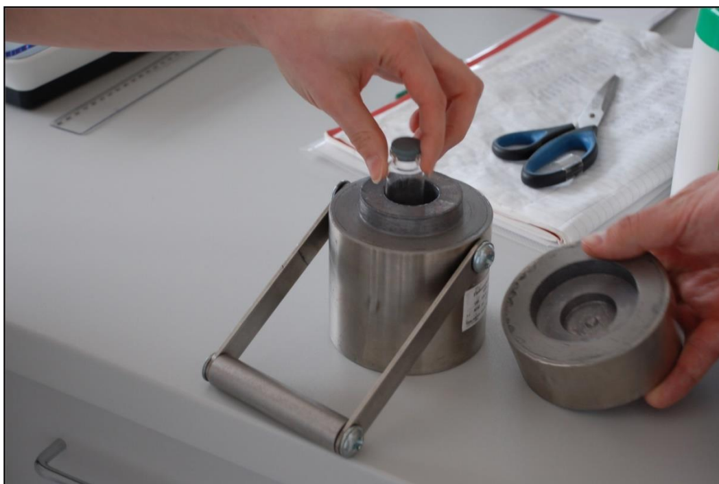
Obrázek - 7 - Detailní snímek stíněné schránky pro uložení radiofarmaka, např. Deoxyglukózy
