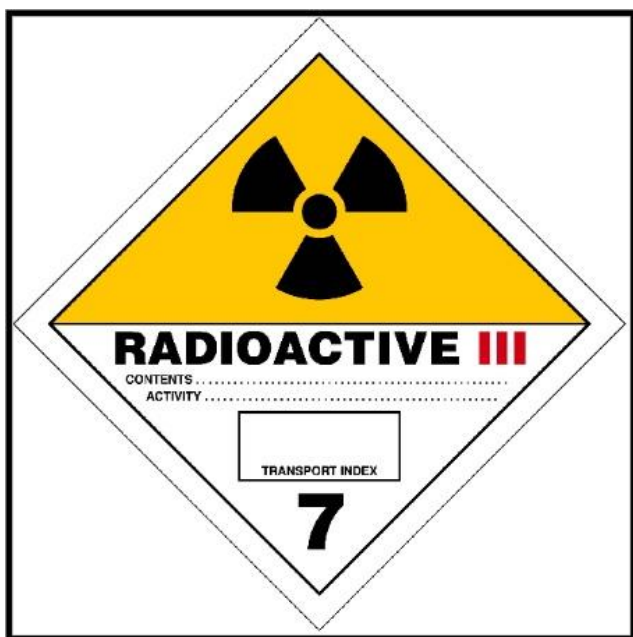
Obrázek 11 - Ukázka označení vozidla převážející radioaktivní látku třídy 7 C podle ADR 23
