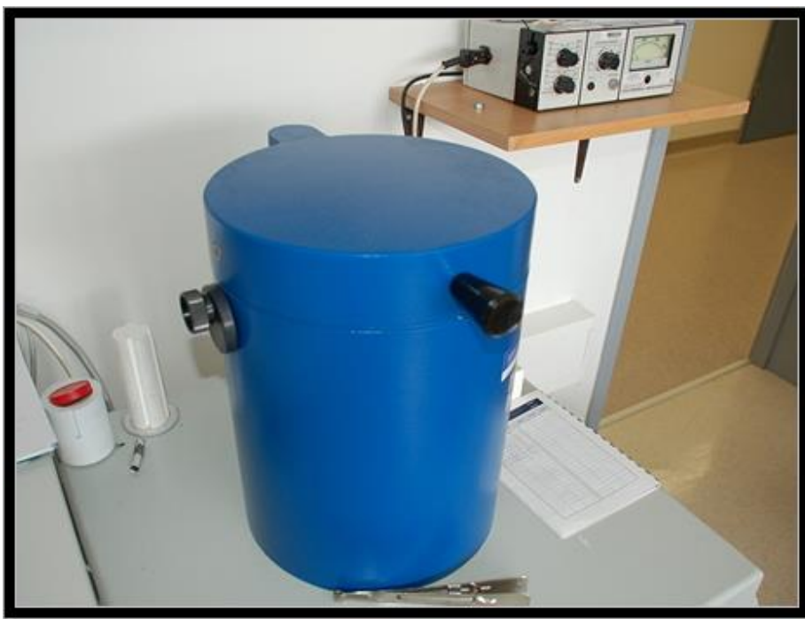
Obrázek 8 - Gamaspektrometr – měření vzorku radiofarmaka v kontejneru
