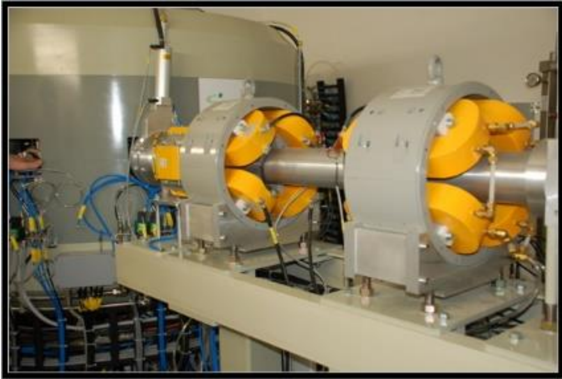
Obrázek 5 - Silné magnety usměrňující tok ionizujícího záření po terčích v kolimátoru viz obr. 7
