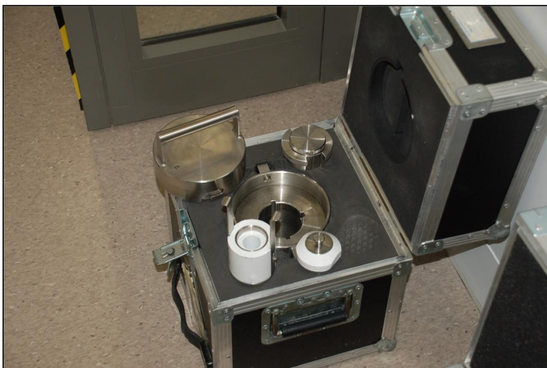
Obrázek - 6 - Detail uložení schránek radiofarmak v přepravním kontejneru
