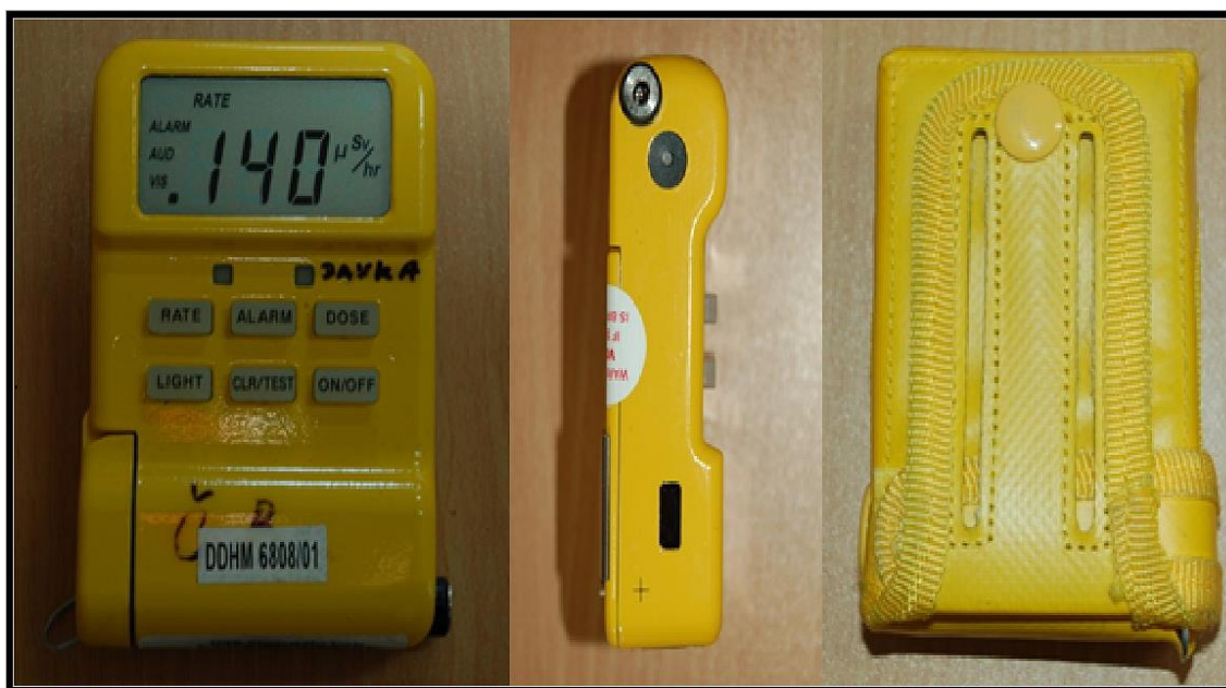
Obrázek 13 - Zásahový dozimetr HZS označení URAD 115
