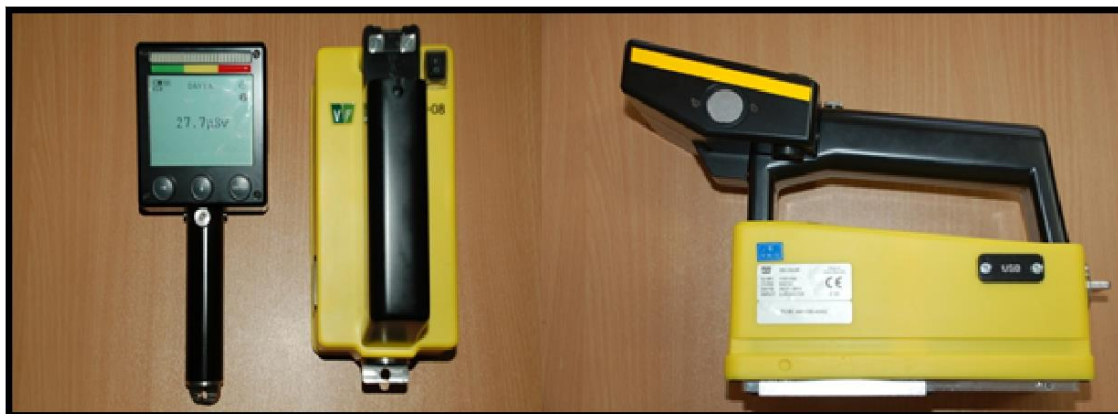
Obrázek 15 - Radiometr používaný u jednotek HZS
