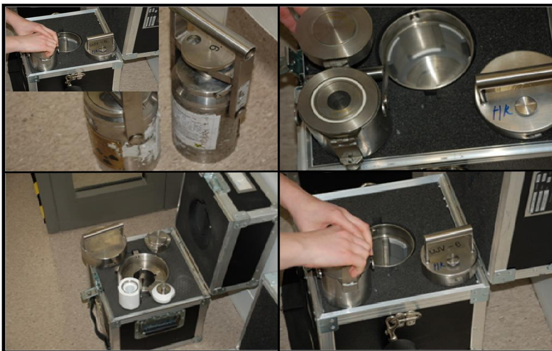
Obrázek 10 - Ukládání radiofarmak do přepravních schránek a přepravního kontejneru
