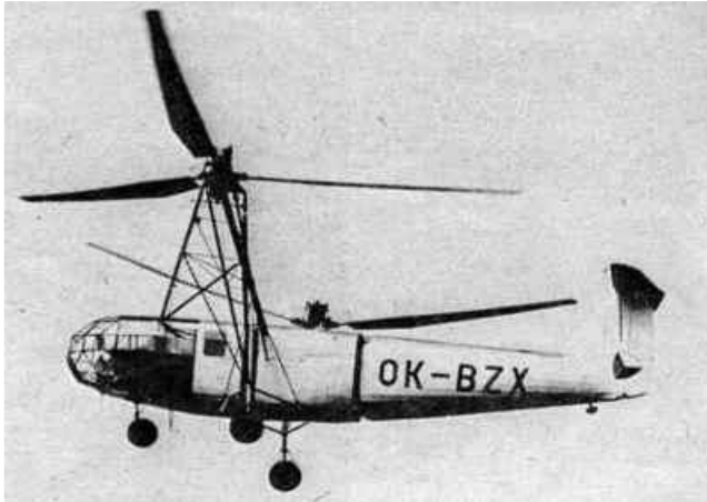
Obr. č. 1 - Focke Achgelis Fa-223 (VR-1). Dostupné z: http://www.vrtulnik.cz/fa-223.htm
