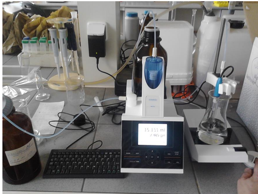
Obr. III: Titrace vzorků kompostu při měření obsahu dusíku
