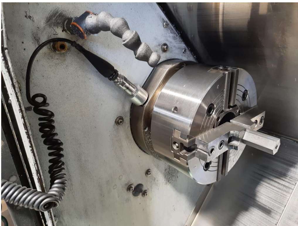
Obr. 17 Uchycení piezoelektrického snímače v místě měření 3L magnetickým způsobem
