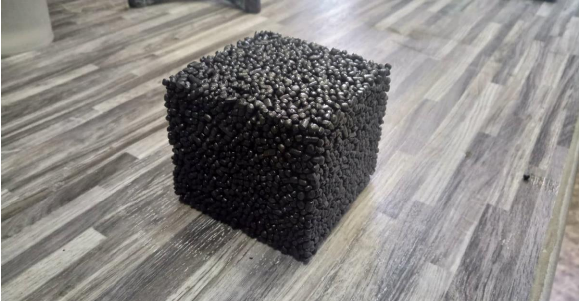
Obrázek 18: Vzhled vzorku směsi č.2 s epoxidovou pryskyřicí (foto autor)
