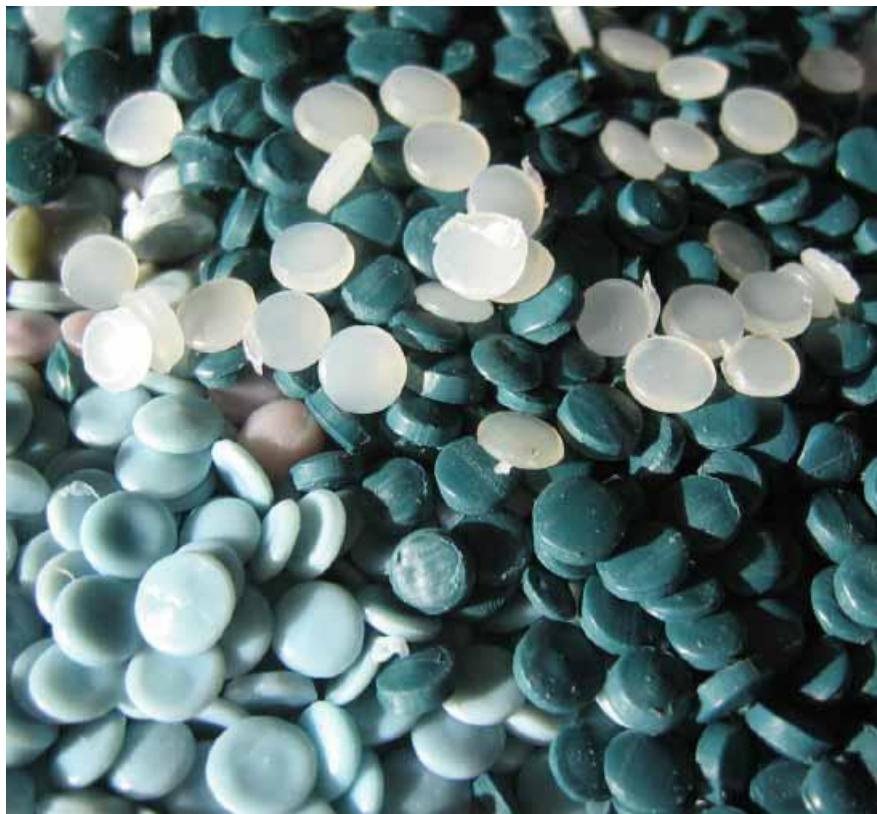
Obrázek 6: Vzhled regranolátu z recyklační linky [45]
