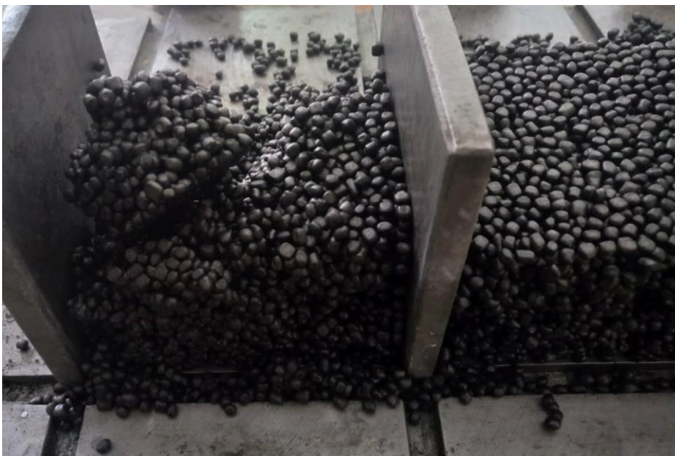
Obrázek 20: Spékané vzorky EPP po odformování. (foto autor)
