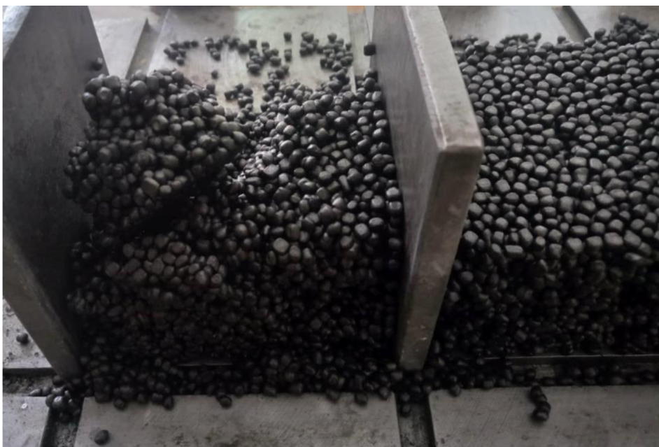
Obrázek 20: Spékané vzorky EPP po odformování. (foto autor)
