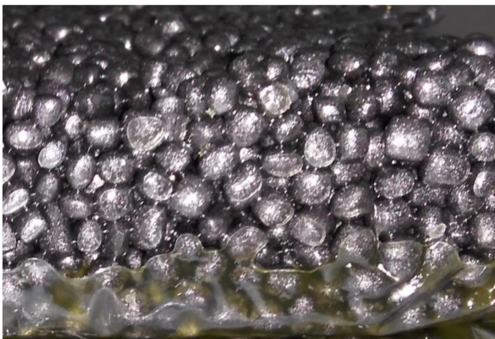
Obrázek 17: Vzhled vzorku směsi č.1 s přebytkem pojiva (foto autor)
