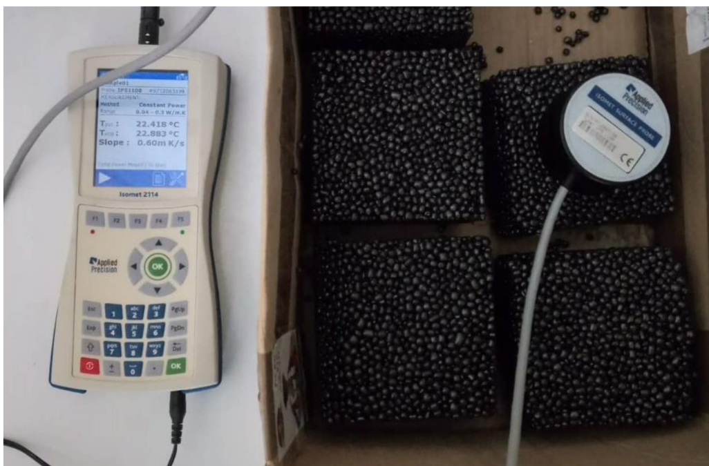
Obrázek 14: Měření součinitele tepelné vodivosti \lambda příložnou sondou ISOMET.
