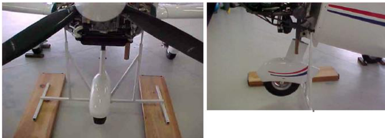
Obr. 2.1 Predný podvozok lietadla TL 2000 Sting S4 [7]
