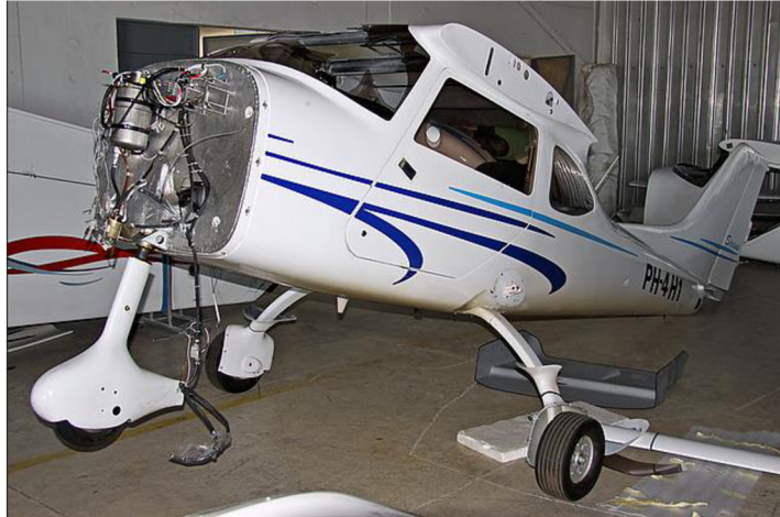
Obr. 2.4 Predný podvozok lietadla TL 3000 Sirius [9]
