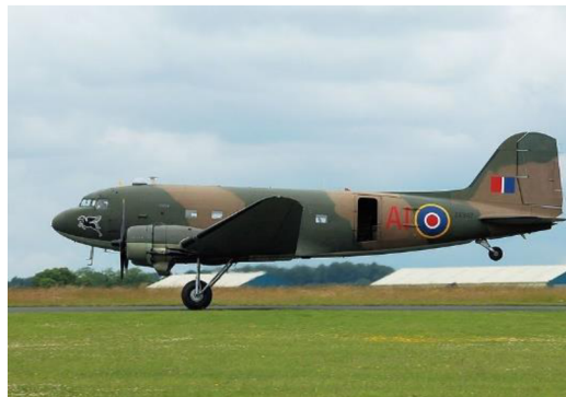
Obr. 1.1 Letún s ostruhovým kolesom DC 3 [1]
