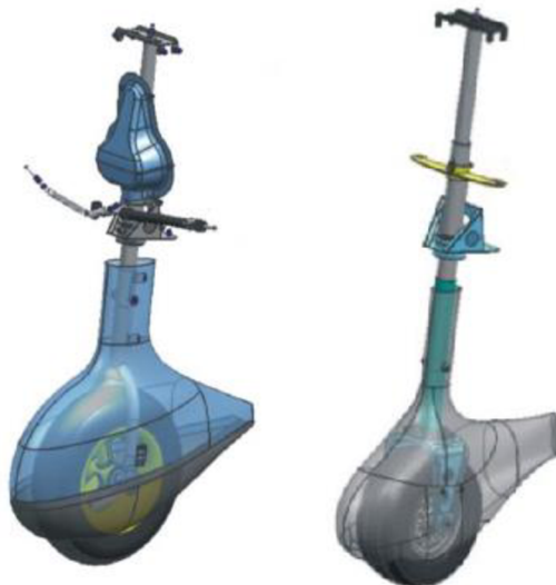
Obr. 2.5 Neriadený predný podvozok (vľavo) a riadený predný podvozok (vpravo) [10]
