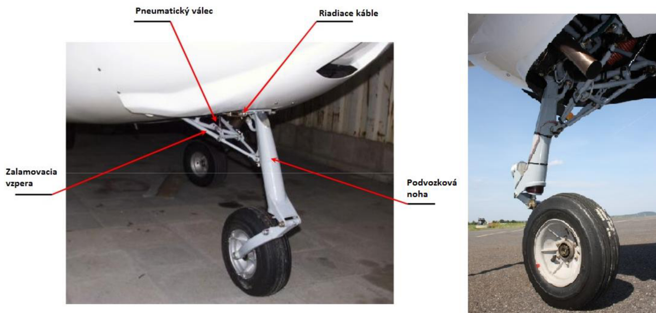
Obr. 2.13 Detail zaťahovacieho predného podvozku [17] [18]
