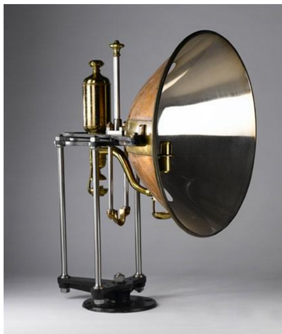
Obr. 1 Reflektor používaný v majákoch [3].
