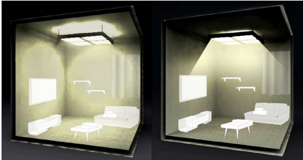
Obr. 14 Priame (vľavo) a nepriame (vpravo) osvetlenie miestnosti [16].
