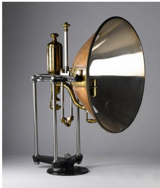
Obr. 1 Reflektor používaný v majákoch [3].
