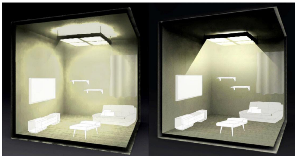
Obr. 14 Priame (vľavo) a nepriame (vpravo) osvetlenie miestnosti [16].
