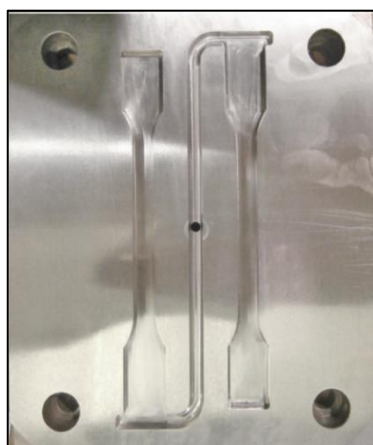
Obr. 12 Tvarová část vstřikovací formy ISO dle normy ČSN EN ISO 294–1
