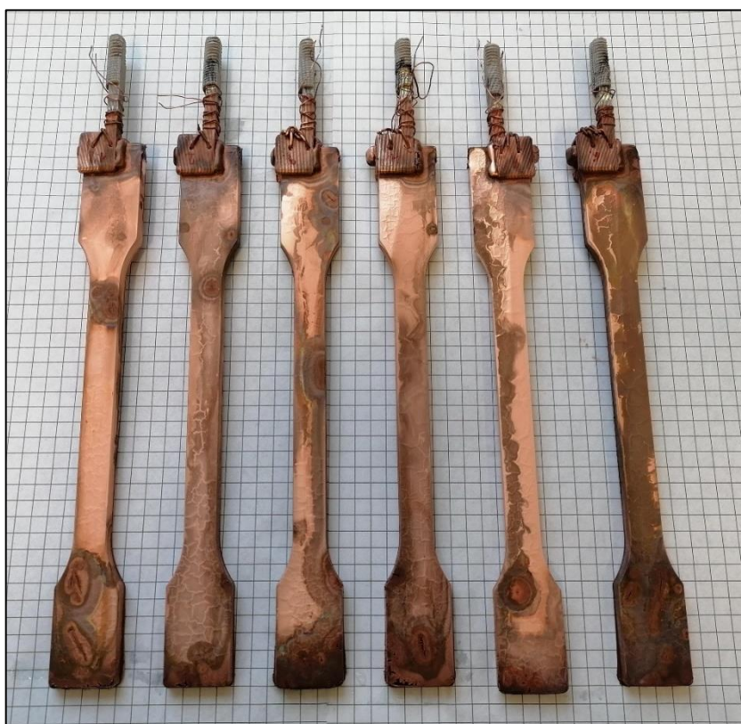
Obr. P1.4 Pokovená tělesa určená pro tahovou zkoušku ze vstřikovaného PA 12 s připevňujícími uchyceními
