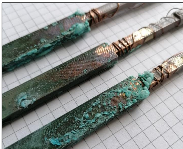
Obr. 13 Krystalizace síranu měďnatého s tvorbou oxidů mědi na povrchu nanesené kovové vrstvy na zkušebních tělesech z PET-G s nevhodně upraveným povrchem
