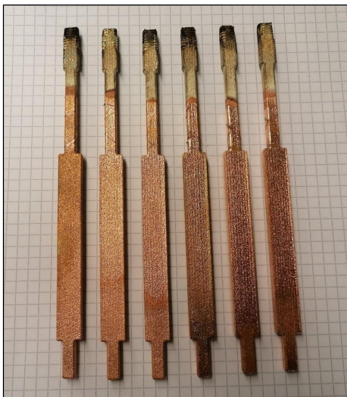
Obr. P1.1 Pokovená tělesa určená pro ohybovou zkoušku z materiálu PA 12 – MJF
