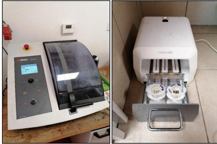
Obr. 24 Kotoučová rozbrušovací pila Secotom – 50 od společnosti Struers (vlevo), dva ze tří vzorků po vytvrzení v UV peci Technotray POWER (vpravo)
