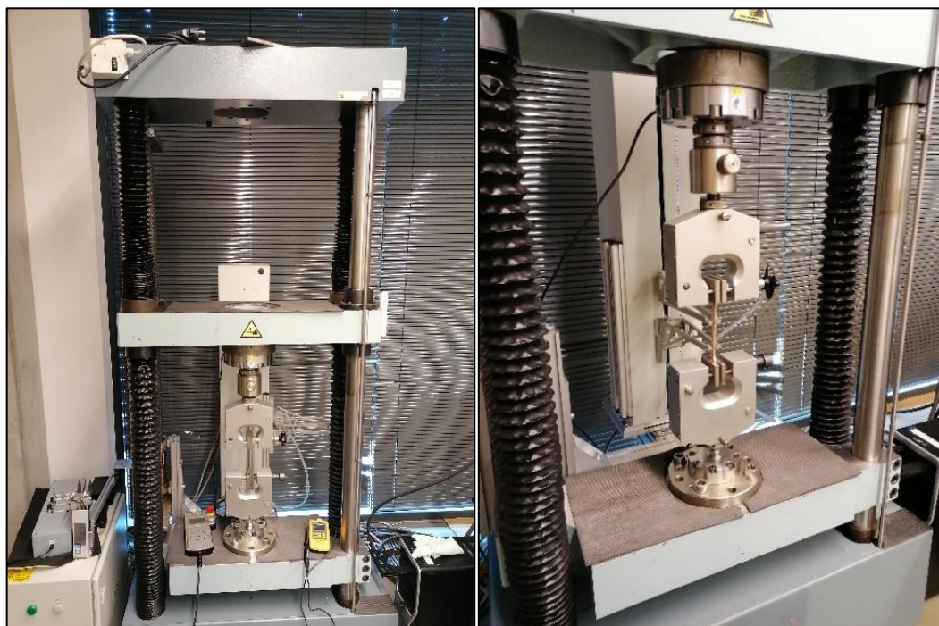
Obr. 18 Trhačí zařízení TiraTest 2300 (vlevo), detail měření tahových vlastností (vpravo)
