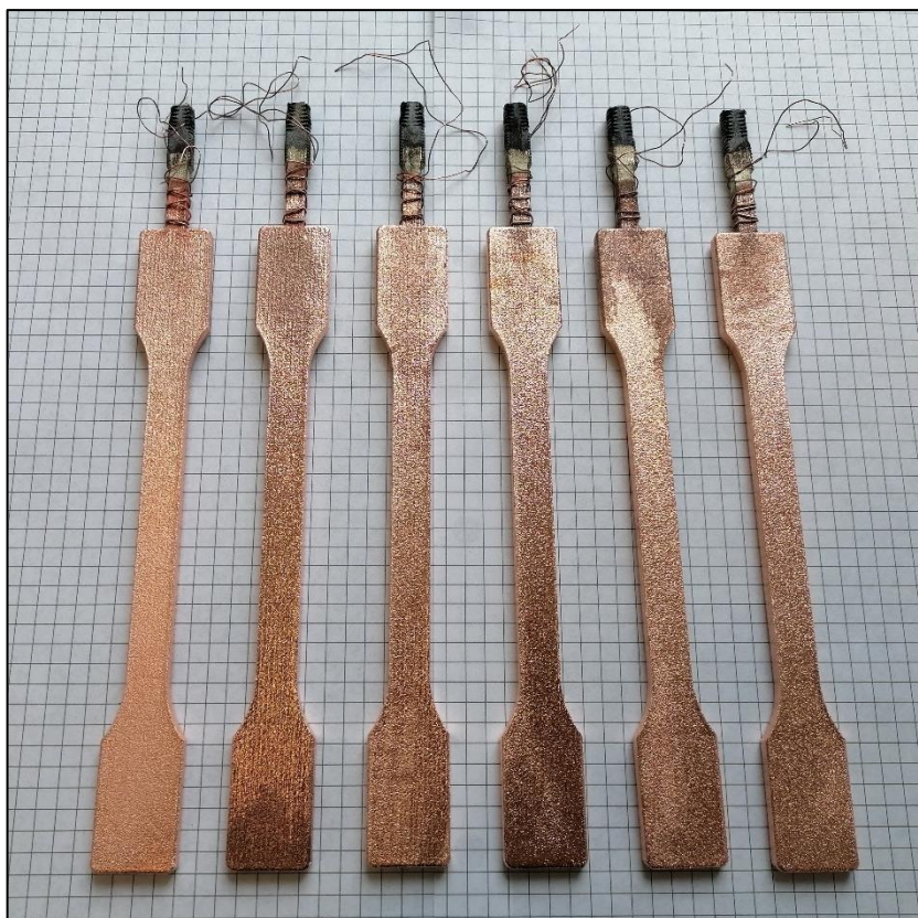
Obr. P1.3 Pokovená tělesa určená pro tahovou zkoušku z materiálu PA 12 – MJF
