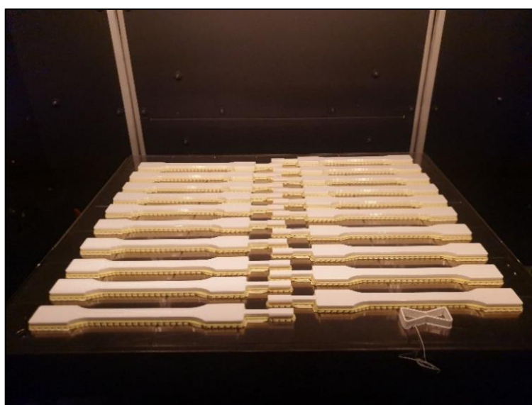
Obr. 10 Vytisknutá zkušební tělesa z materiálu ABS těsně před vyjmutím z 3D tiskárny Fortus 450mc
