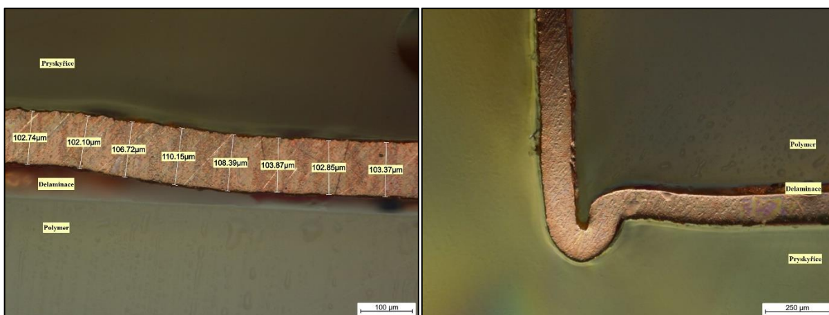
Obr. 47 Měření tloušťky měděné vrstvy struktur z materiálu vstřikovaného PA 12 a) měření tloušťky měděné vrstvy, b) pohled na hranu měřeného vzorku
