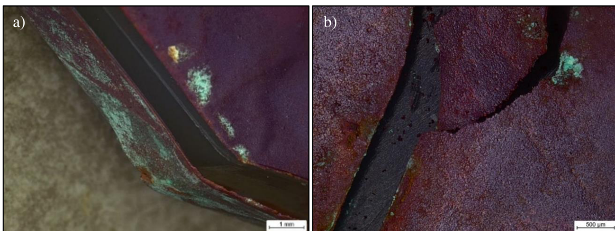
Obr. 43 Povrch struktury z materiálu vstříkovaného PA 12 a) v průběhu klimatického testu (po 5 dnech), b) po ukončení klimatického testu (po 10 dnech)
