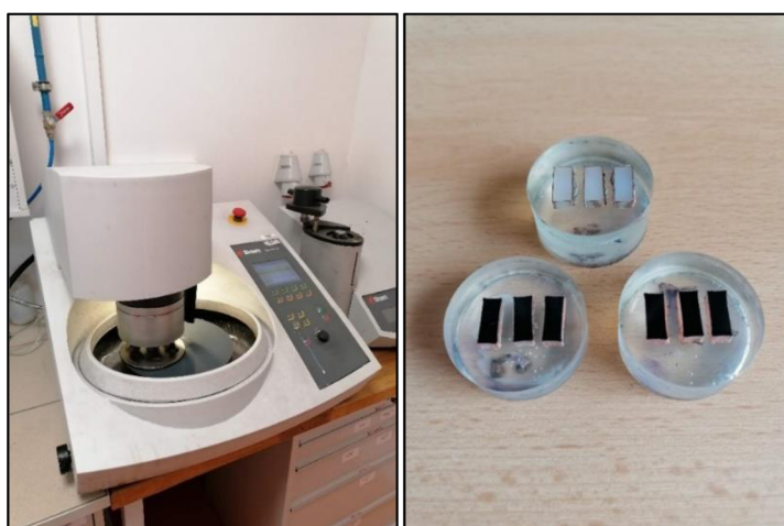
Obr. 25 Metalografická bruska Tegramin – 25 od společnosti Struers (vlevo), vzorky po metalografickém výbrusu připravené pro měření tloušťky kovové vrstvy (vpravo)
