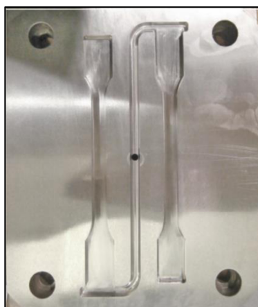
Obr. 12 Tvarová část vstřikovací formy ISO dle normy ČSN EN ISO 294–1
