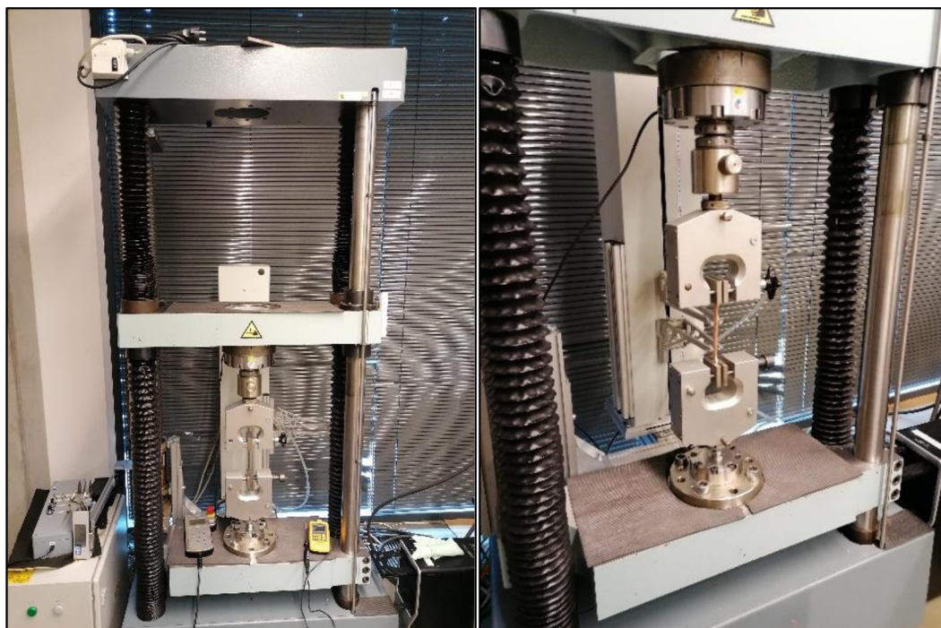
Obr. 18 Trhací zařízení TiraTest 2300 (vlevo), detail měření tahových vlastností (vpravo)
