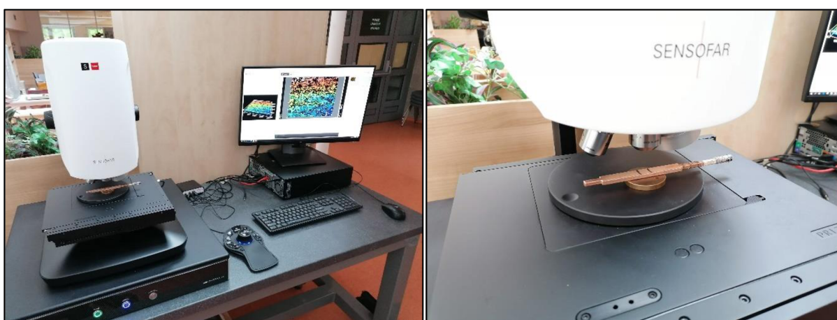
Obr. 20 Konfokální mikroskop Sensofar S neox (vlevo), detail sledování integrity povrchu struktur polymer – kov (vpravo)
