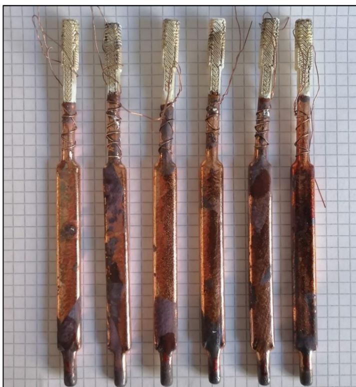
Obr. P1.2 Pokovená tělesa určená pro ohybovou zkoušku z materiálu ABS
