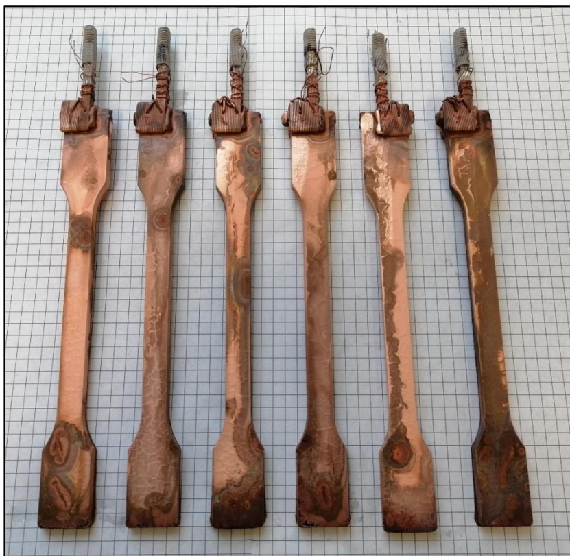
Obr. P1.4 Pokovená tělesa určená pro tahovou zkoušku ze vstřikovaného PA 12 s připevněnými uchyceními
