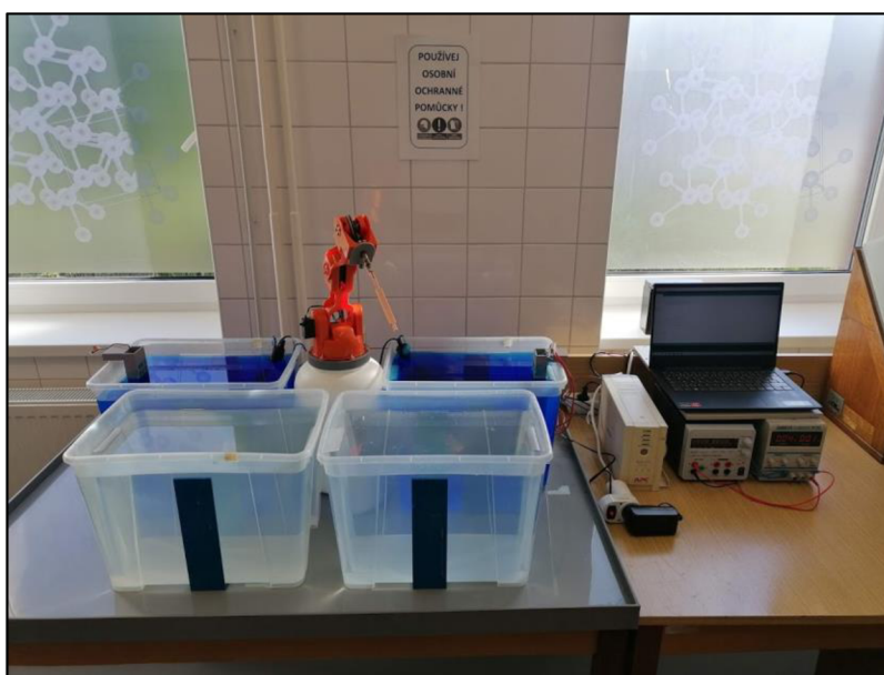
Obr. 17 Robotický elektrolyzátor po skončení pokovovacího procesu s ovládací stanicí CAM a se zdroji elektrické energie
