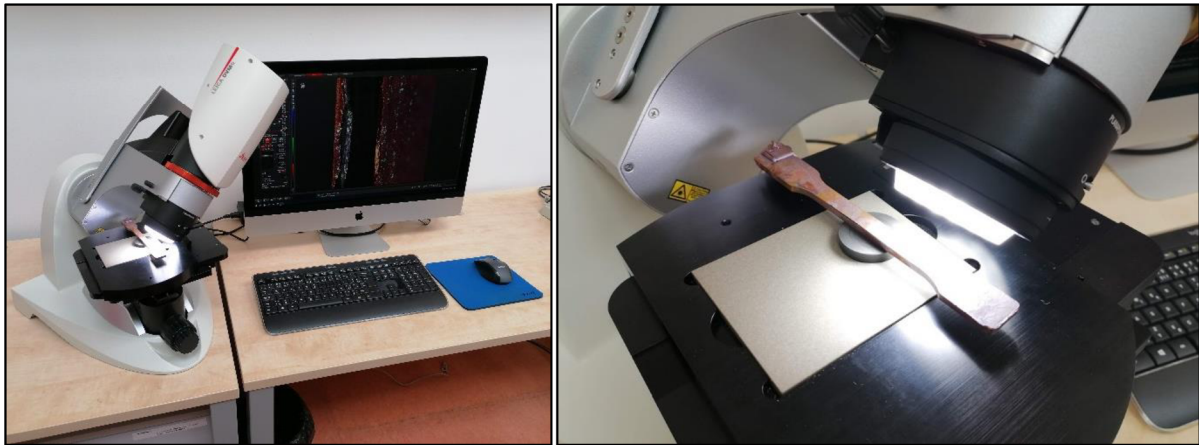
Obr. 23 Digitální optický mikroskop Leica DVM6 (vlevo), detail snímání povrchu kovové vrstvy zkušební tělesa (vpravo)
