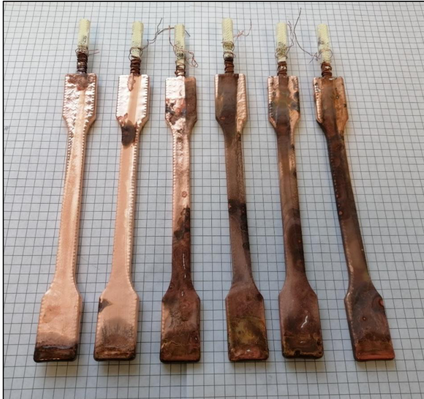
Obr. P1.5 Pokovená tělesa určená pro tahovou zkoušku z materiálu ABS
