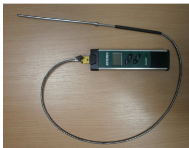
Obr. 30 Sestava teploměru Atkinson a teplotní sondy pro měření teploty oleje (Autor)
