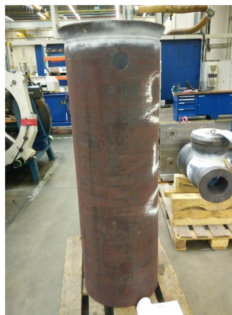
Obr. 6 Svarek vložky: kónus + trubice
