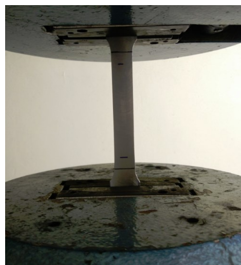
Obr. 32 Upnutí vzorku do kleštin
