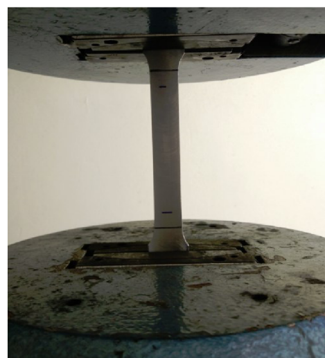
Obr. 32 Upnutí vzorku do kleštin
