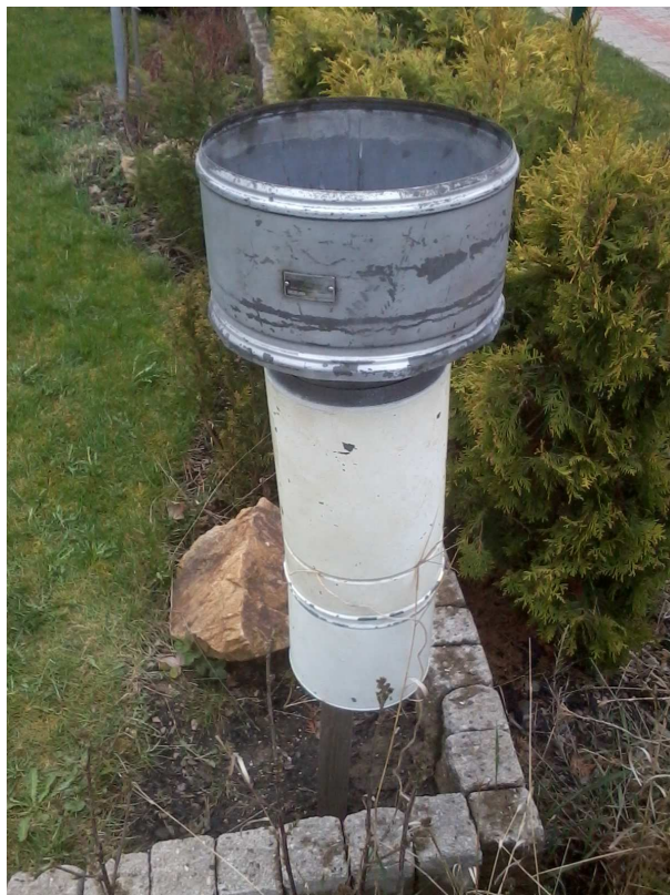
Obr. 3.2 Fotografie dočasné srážkoměrné stanice
