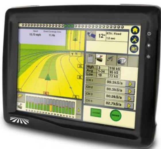
Obr. 10: Palubní GNSS přijímač pro zemědělské účely (AGROTEC, 2014).
