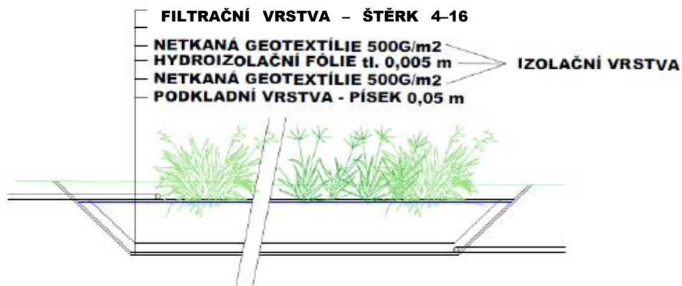
Obrázek 48: Vrstvy horizontálního filtračního pole.
