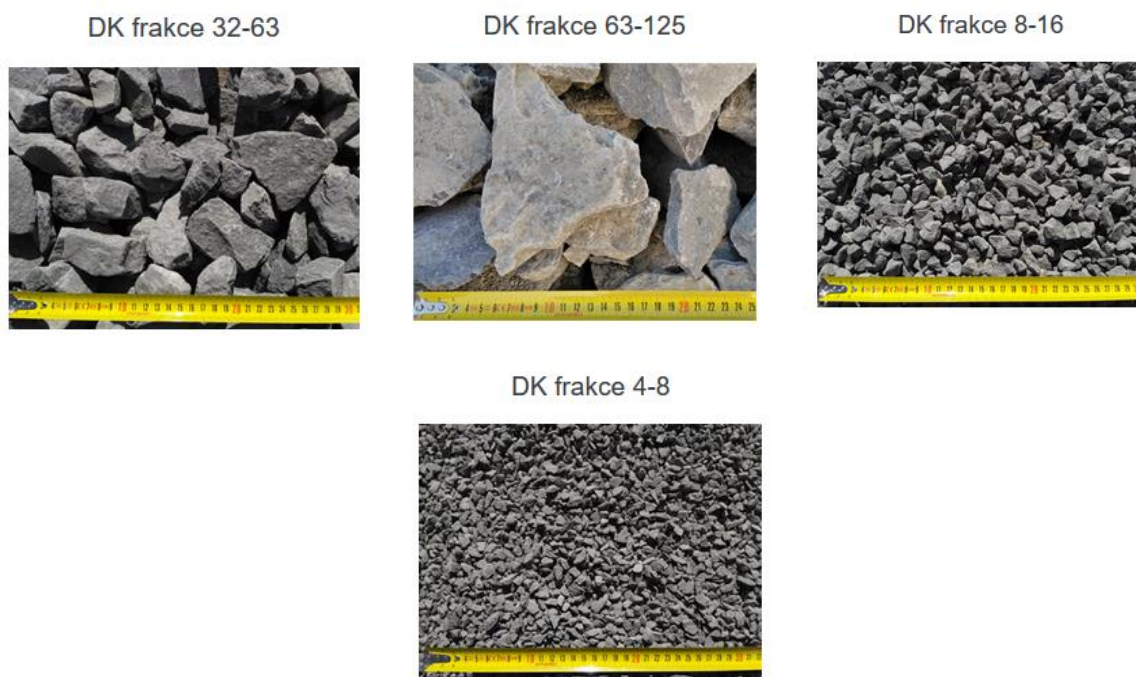
Obrázek 24: Frakce štěrku DK – drcené kamenivo(dumzahrada.cz).
