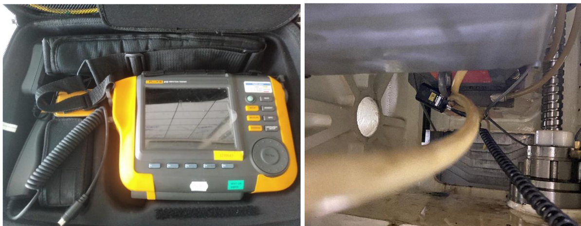
Obr. 28) Měřicí zařízení Fluke 810 a umístění senzoru
