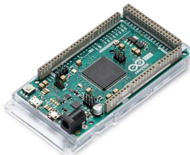
Obr. 60) Mikrokontroler s ARM procesorem [44]
