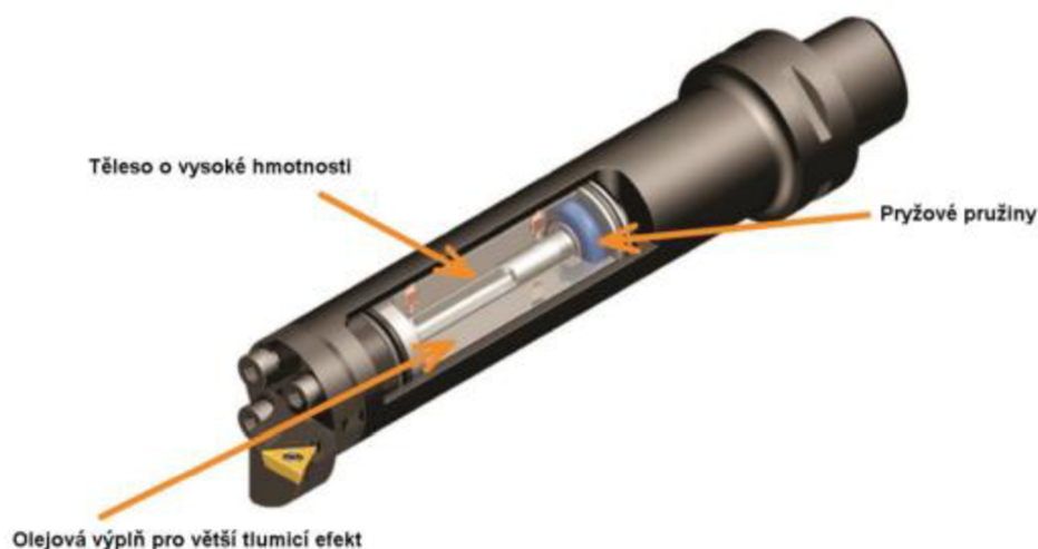
Obr. 47) Schéma vyvrtávací tyče s pasivním tlumením [36]
