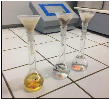
Obrázek č. 7: Filtrace roztoku s rozloženým sedimentem do baňky o objemu 50 ml v digestoři.
