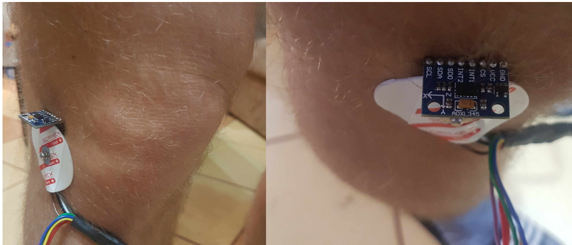
Obr. 4.5: Zobrazenie umiestnenia akcelerometra ADXL345 pri meraní kolenného kĺbu pomocou mnou navrhnutého prístroja.
