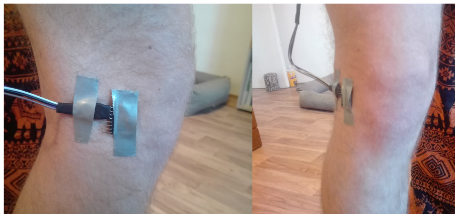
Obr. 4.9: Zobrazenie umiestnenia akcelerometra MPU6050 pri meraní kolenného kĺbu pomocou mnou navrhnutého prístroja.
