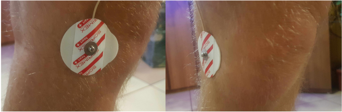
Obr. 4.1: Zobrazenie umiestnenia akcelerometra Biosignals Flux pri meraní kolenného kĺbu
