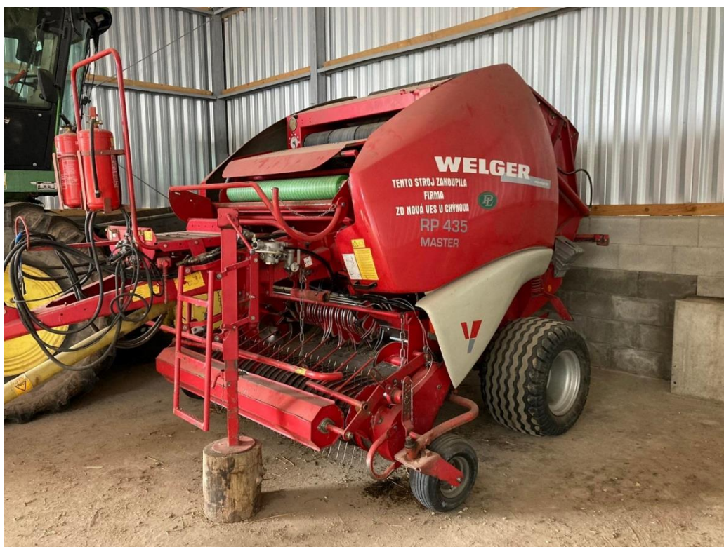
Obrázek 4.1: Lis Welger RP 435 s variabilní komorou (Vlastní obrázek, 2023)
