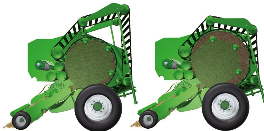
Obrázek 2.6: Variabilní komora (Lectura-specs.cz, 2023)
