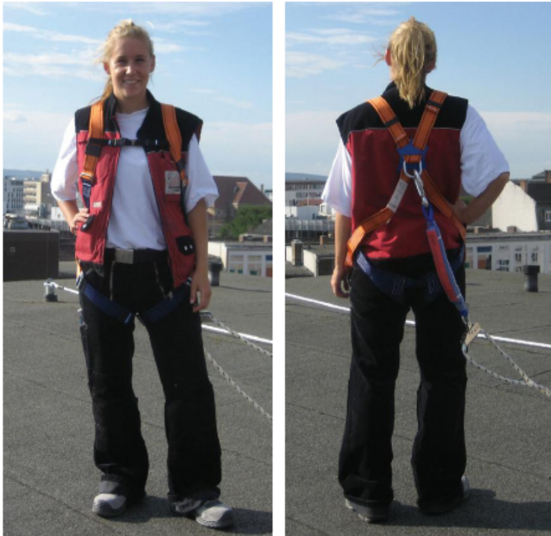
Obr. Vzorové upevnění bezpečnostního postroje včetně příslušenství
