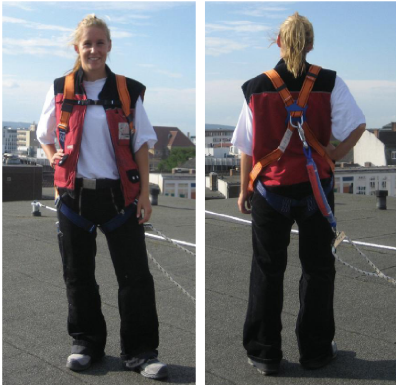
Obr. Vzorové upevnění bezpečnostního postroje včetně příslušenství
