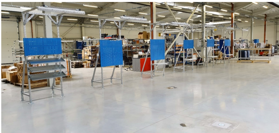
Obr. 64 Příprava taktů první výrobní linky schodišťových plošin před podlahovým ukotvením Zdroj: Autor
