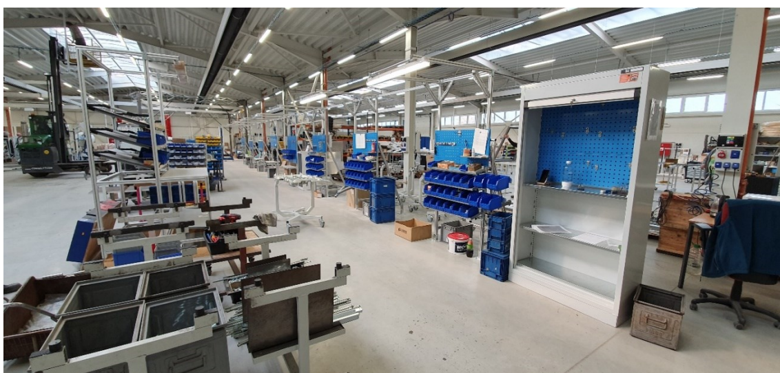
Obr. 78 Oživování druhé montážní linky schodišťových plošin, bez náradí a 5S vizualizace Zdroj: Autor
