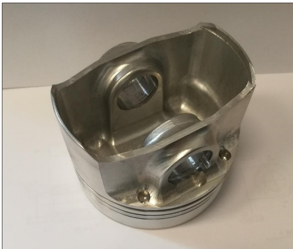
Obr. č. 22: Píst spalovacího motoru vyráběný firmou ENGITEC.
