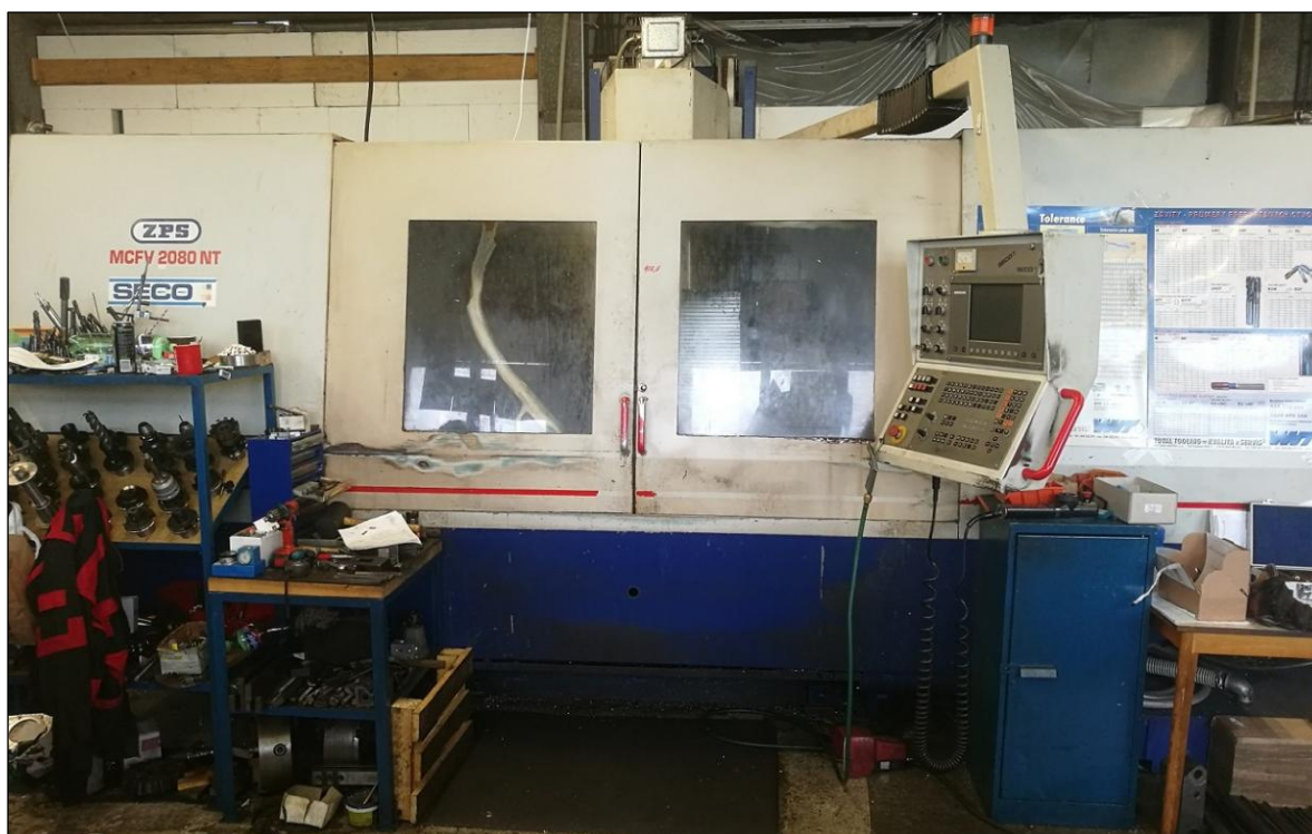
Obr. č. 23: Současné CNC obráběcí centrum ZPS MCFV 2080 NT
