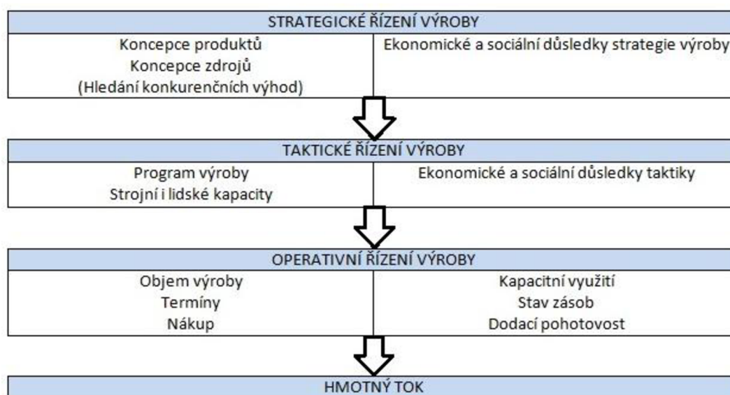
Obr. č. 2: Řídící veličiny řízení výroby. [23]
