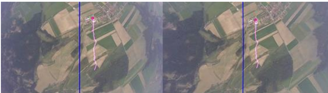
Obr. 26 Korekce soudkovité zobrazení obrazu. Vlevo originální záběr vpravo digitálně opravený. Modrá čára je rovnoběžná s podélnou osou letadla. Růžová čára značí pohyb referenčního bodu vůči letadlu.
