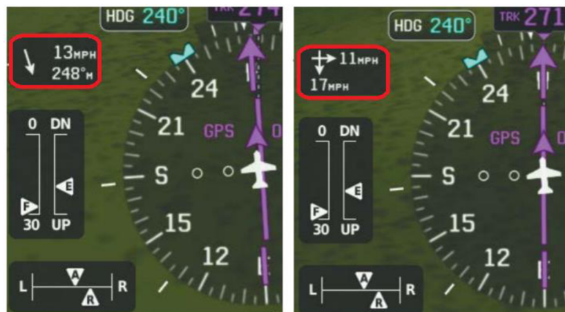
Obr. 24 Indikace parametrů větru Garmin GX3 (červeně zvýrazněný rámeček v levém horním rohu). Levý obrázek ukazuje indikaci magnetického směru a rychlosti v mílech za hodinu 31 . Levý obrázek zobrazuje indikaci rychlostí čelního a bočního větru.
