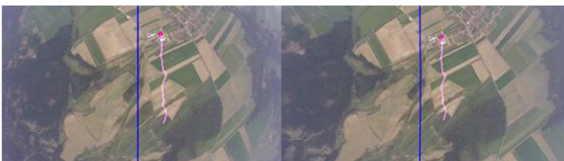
Obr. 26 Korekce soudkovité zobrazení obrazu. Vlevo originální záběr vpravo digitálně upravený. Modrá čára je rovnoběžná s podélnou osou letadla. Růžová čára značí pohyb referenčního bodu vůči letadlu.
