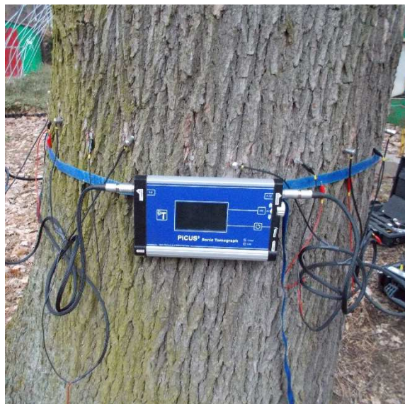
Obr. 2 – Stromový sonický tomograf, zdroj: autor 2015.
