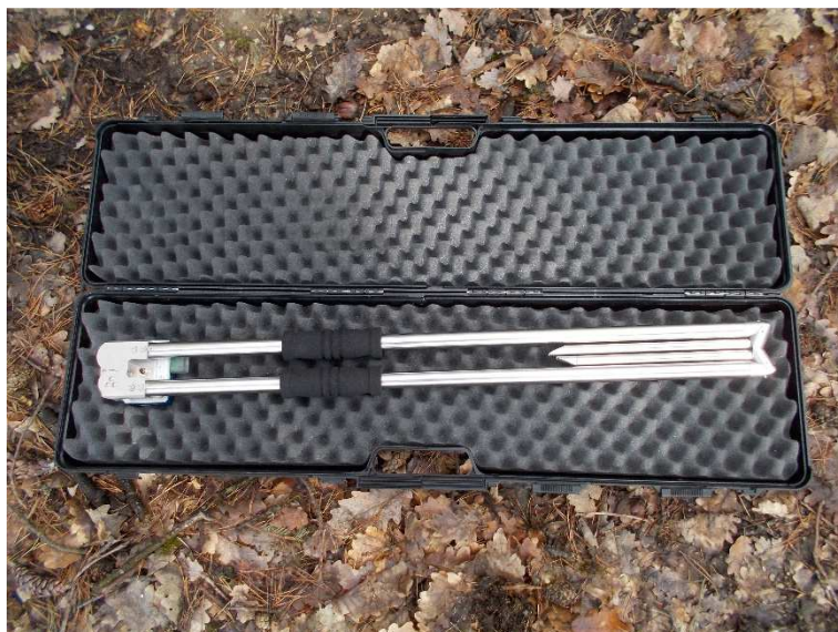
Obr. 138 – Elektronická průměrka, zdroj: autor, 2015.
