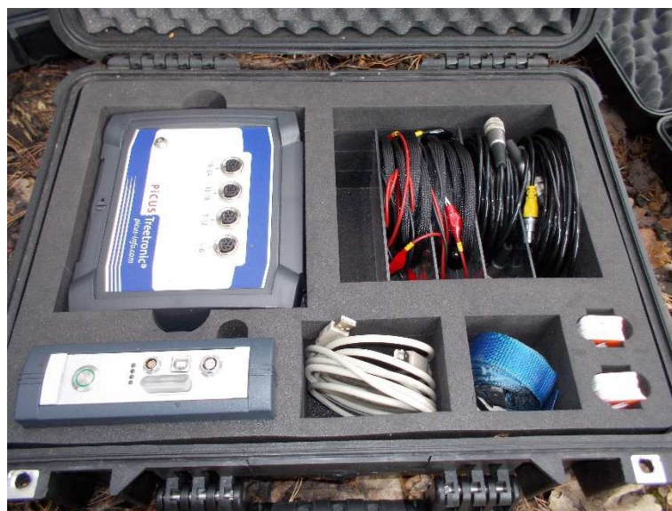
Obr. 139 – Stromový odporový tomograf s příslušenstvím, zdroj: autor, 2015.
