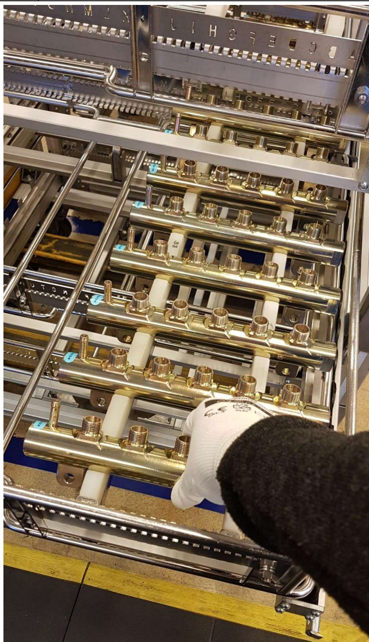
Obr. 29) Depaletizace těles z pracího koše [3]
