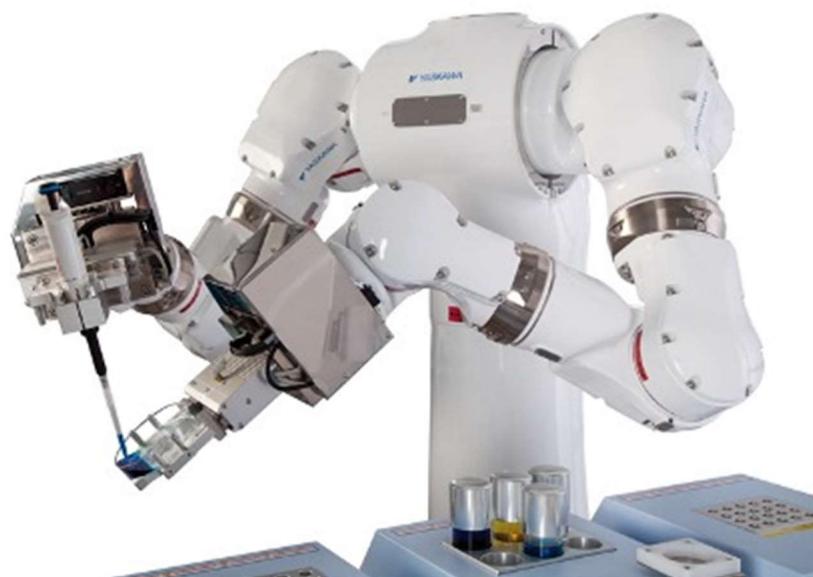
Obr. 8) Dvouramenný robot od výrobce Yaskawa Motoman vhodný do laboratoře [14]
