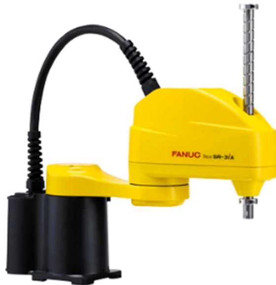
Obr. 6) Robot typu SCARA od výrobce FANUC
