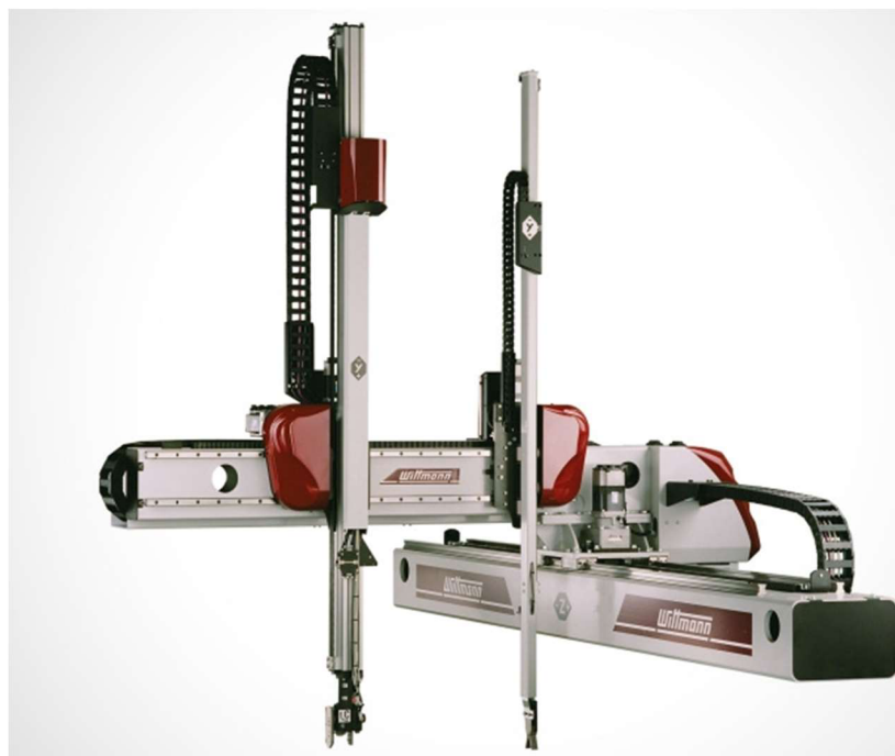
Obr. 5) Karteziánský robot od výrobce Wittmann [11]
