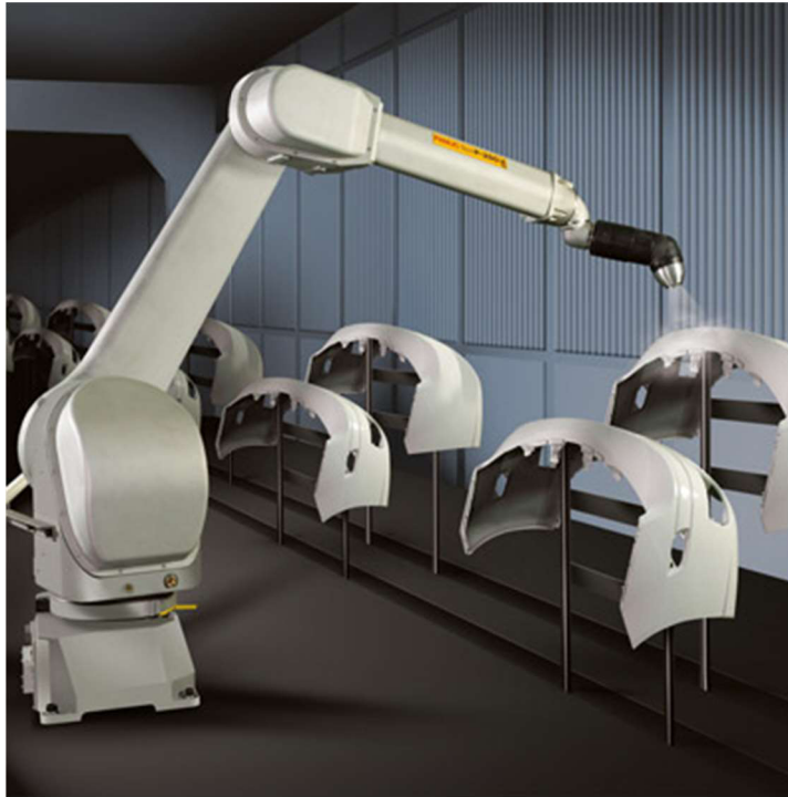
Obr. 10) Lakovací robot od společnosti Fanuc [16]
