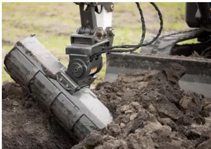
Obr. 6 Naklápění rotačním pohonem [11]
