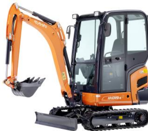
Obr. 29 Minirypadlo Kubota KX019-4 [33]
