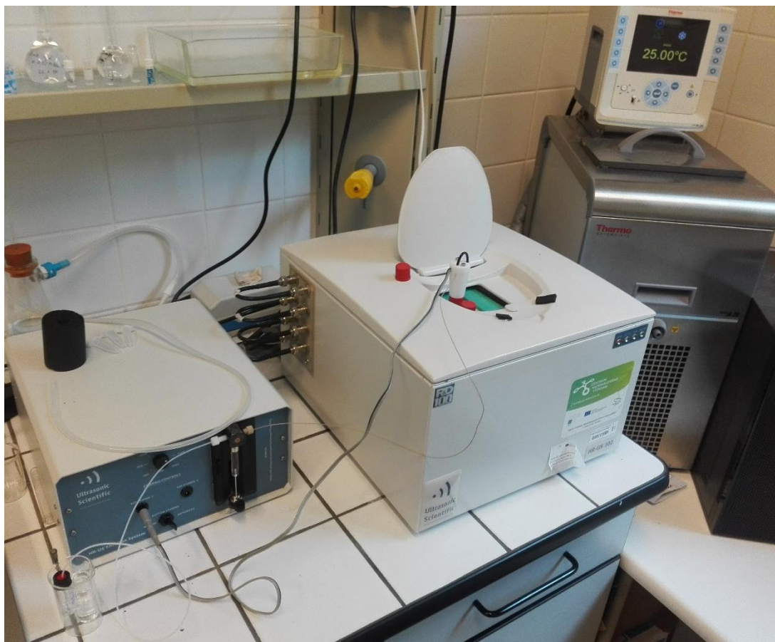
Obrázek 16: Přístroj HRUS 102T vybavený termostatem a automatickým titrátorem.
