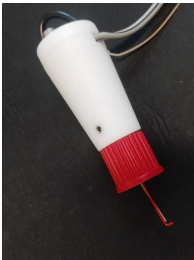
Obrázek 17: Titrační nástavec pro HRUS 102T.
