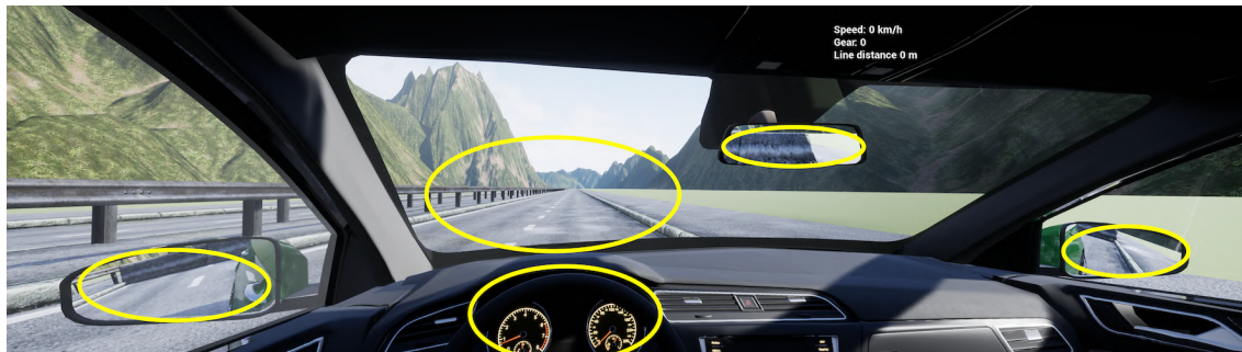
Obr. 3.9: Zóny detekované pomocí klasifikační CNN
